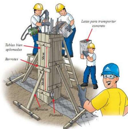
Ilustración N°05. Ejemplo de trabajo productivo (vaciado de concreto en columnas).
