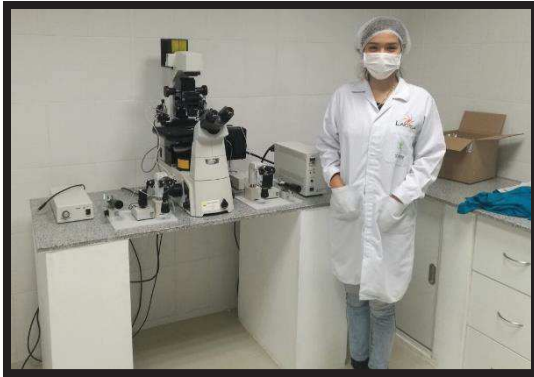
Figura Nro. 31. Micro manipulador Nikon Eclipse Ti-U del Laboratorio Sembryo
