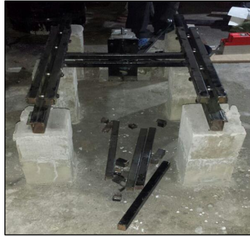
Fuente: Propia – Montaje de rieles y prueba de plataforma móvil.
