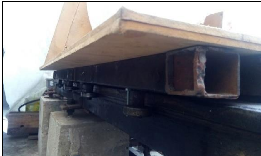
Fuente: Propia – Prueba de plataforma móvil y movimiento de rodamientos.
