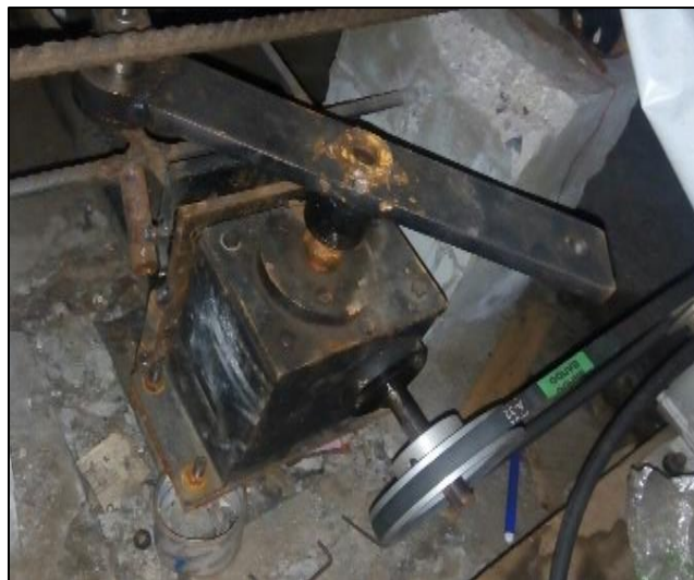
Fuente: Propia – Modo reductor + poleas y faja de transmisión de movimiento.
