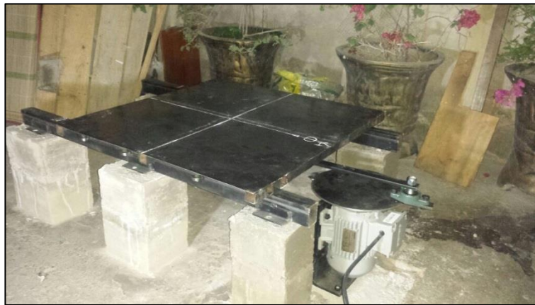
Fuente: Propia – Mesa de vibración terminada – prototipo 01.
