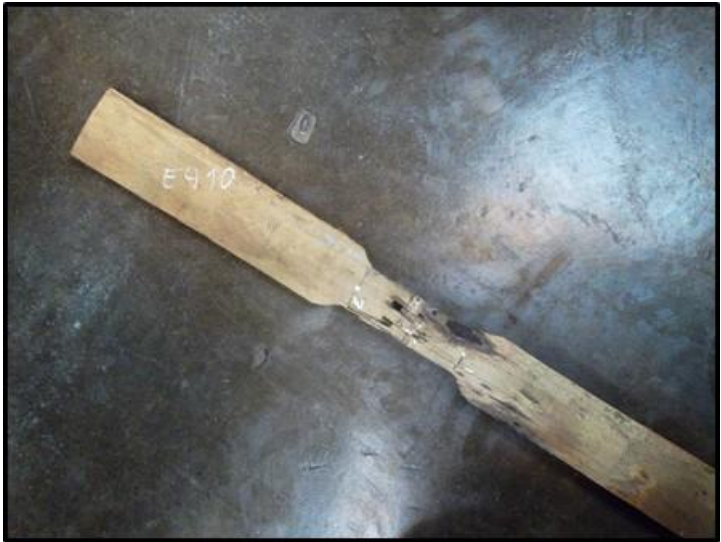
IMAGEN N° 31. Falla típica en ensayo de tracción (muestra con corte).
