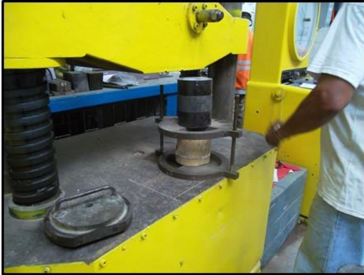
IMAGEN N° 36. Colocación de accesorios para el desarrollo del ensayo de corte.
