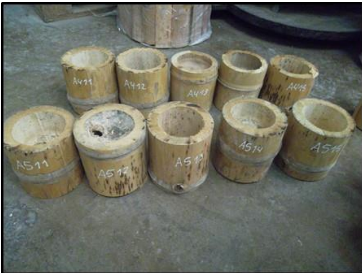
IMAGEN N° 22. Codificación de muestras para ensayo de compresión.
