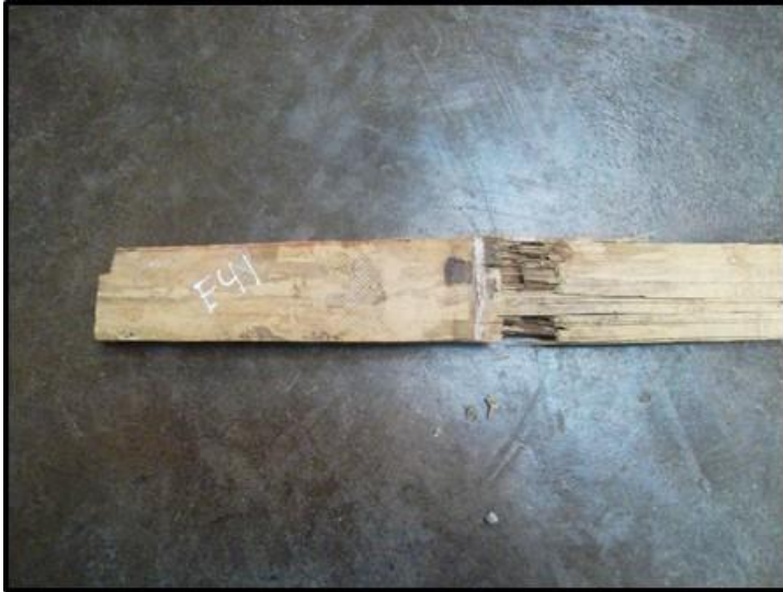
IMAGEN N° 33. Falla típica en el nudo - ensayo de tracción (muestra sin corte).
