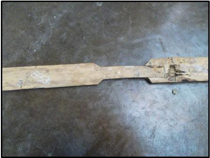
IMAGEN N° 32. Falla típica en el nudo - ensayo de tracción (muestra con corte).
