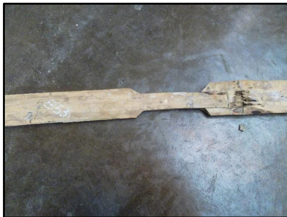
IMAGEN N° 20. Falla por tracción en probeta con corte.
