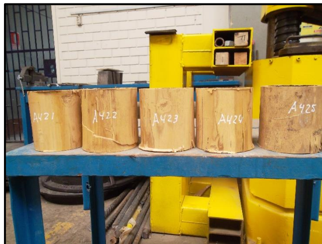
IMAGEN N° 13. Fallas típicas por compresión.
