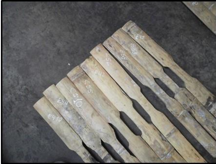
IMAGEN N° 27. Muestras codificadas con corte para ensayo de tracción.
