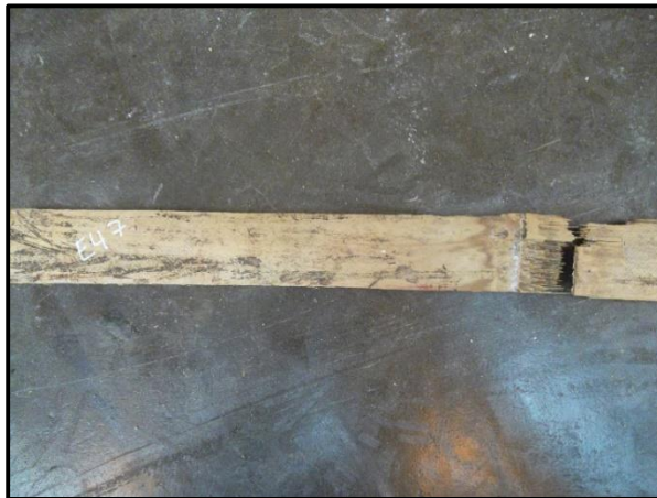
IMAGEN N° 19. Falla por tracción en probeta sin corte.
