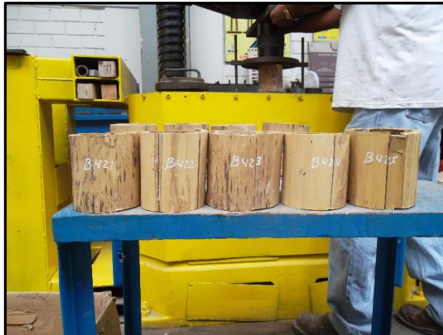
IMAGEN N° 15. Falla típica por corte.
