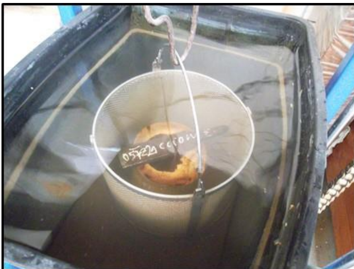
IMAGEN N° 43. Ensayo de densidad básica. Muestra sumergida.
