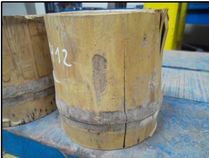
IMAGEN N° 34. Muestra que falló en el ensayo de compresión.
