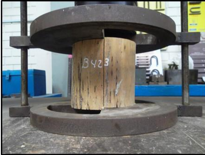
IMAGEN N° 39. Falla típica por corte.
