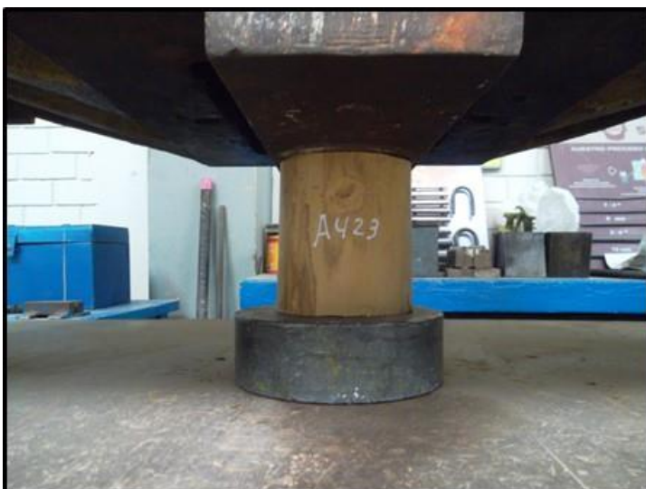
IMAGEN N° 35. Ensayo de compresión paralela a la fibra.
