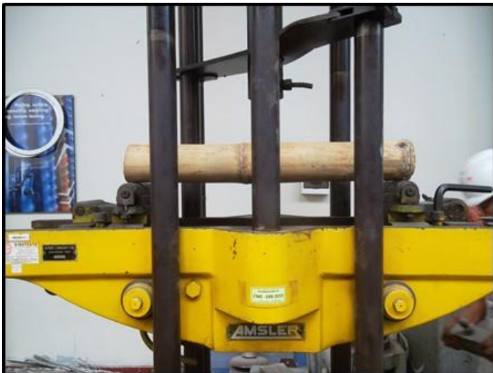
IMAGEN N° 40. Colocación de muestra en la máquina para realizar el ensayo de flexión.
