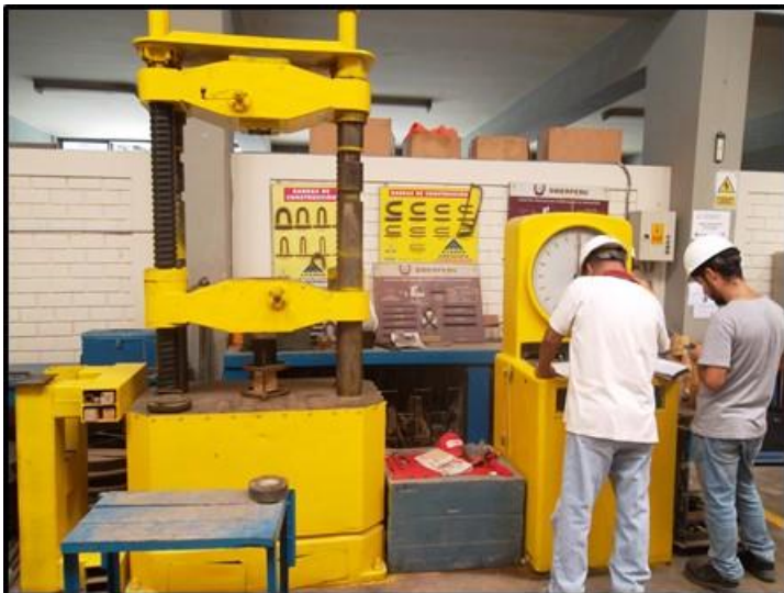
IMAGEN N° 37. Máquina empleada en ensayos de compresión y corte.
