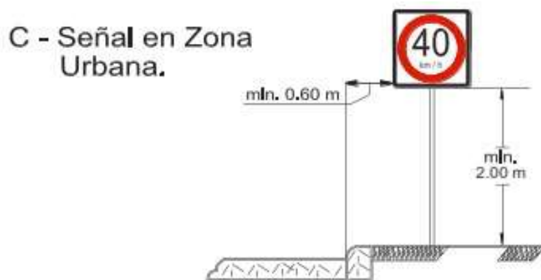
Figura 11 : Ubicación lateral y de altura en vía
