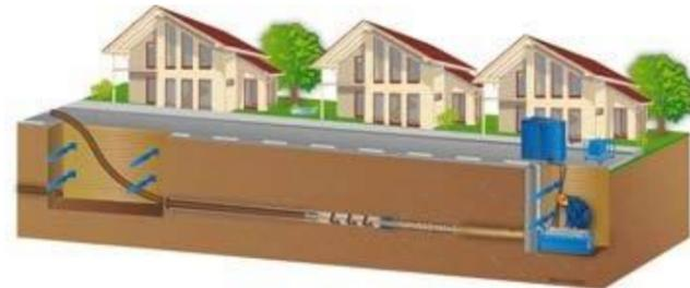
**Renovación de tuberías:** Para tuberías largas o cortas. Tuberías viejas con incrustaciones, se pueden acoplar accesorios de limpieza a las barras de tiro. Suelta y extrae las incrustaciones de la tubería vieja durante el tiro de la tubería nueva.
