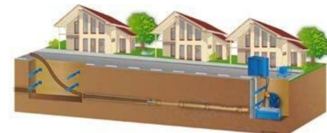
**Calibración-Berstlining:** Los daños parciales en la tubería vieja se ensanchan con el sistema estático GRUNDOBURST o con el sistema dinámico GRUNDOCRACK y al mismo tiempo se introduce la tubería nueva. El espacio libre resultante de debería rellenar.
