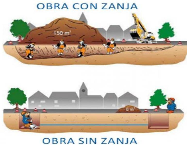
**Figura N° 01: Sustitución de tuberías para agua potable con zanja y sin zanja.**
