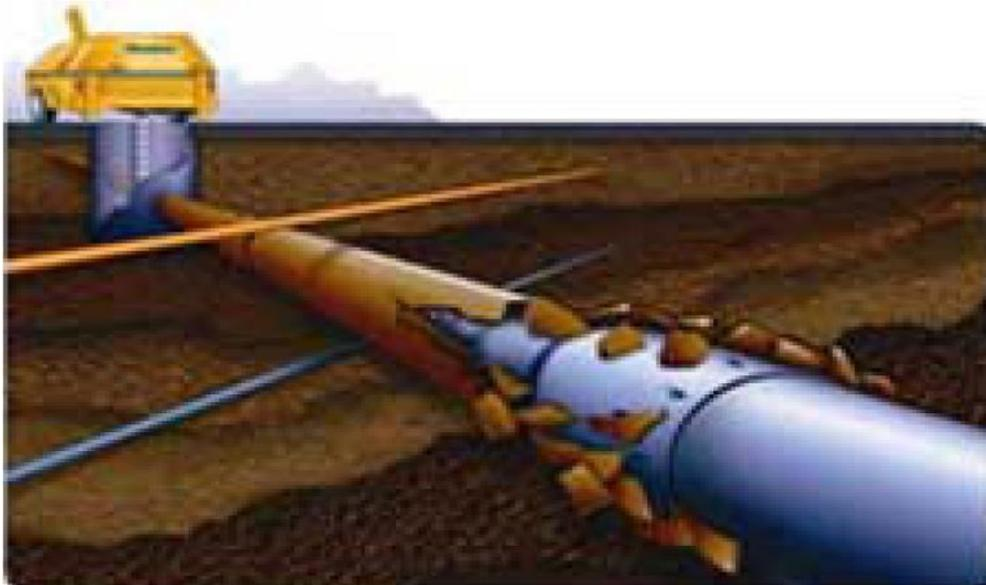
**Figura N° 07: Proceso del uso del método de fractura de tubería, visto en una tubería en el suelo.**
