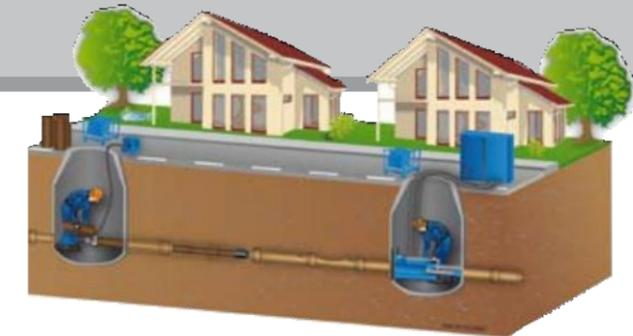
**Renovación con el sistema Tight in Pipe (TIP):** En el sistema TIP se utiliza tanto tubería corta como tubería larga para realizar Renovación en tuberías de hormigón y gres. Normalmente se utiliza una tubería nueva de Polipropileno (PP-HM), que va muy ceñida a la tubería vieja (Tight-In-Pipe). El mínimo espacio que queda entre las dos tuberías no tiene que rellenarse.
