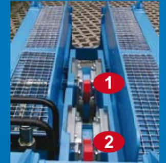
Todas las máquinas van equipadas con un sistema de enganche de las barras. Los bulones de tiro patentados, impiden el retroceso de las barras. El bulón delantero (2) fija la barra, el bulón trasero (1) empuja/tira del tramo de barras.
