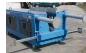
Barras telescópicas para el apoyo trasero y lateral para los modelos 1250, 1900 y 2500 G
