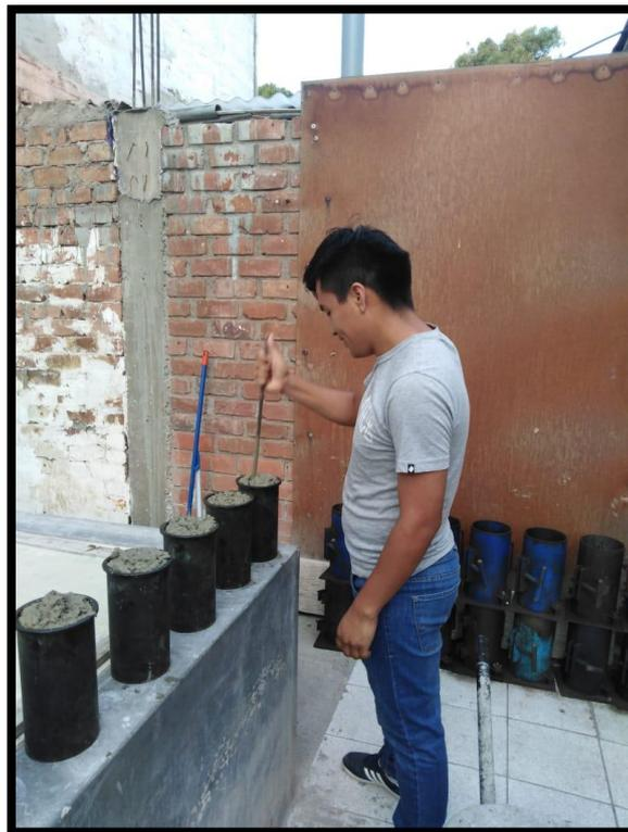
Imagen N° 12: realizamos las probetas de concreto según norma ASTM C39/NTP 339.034
