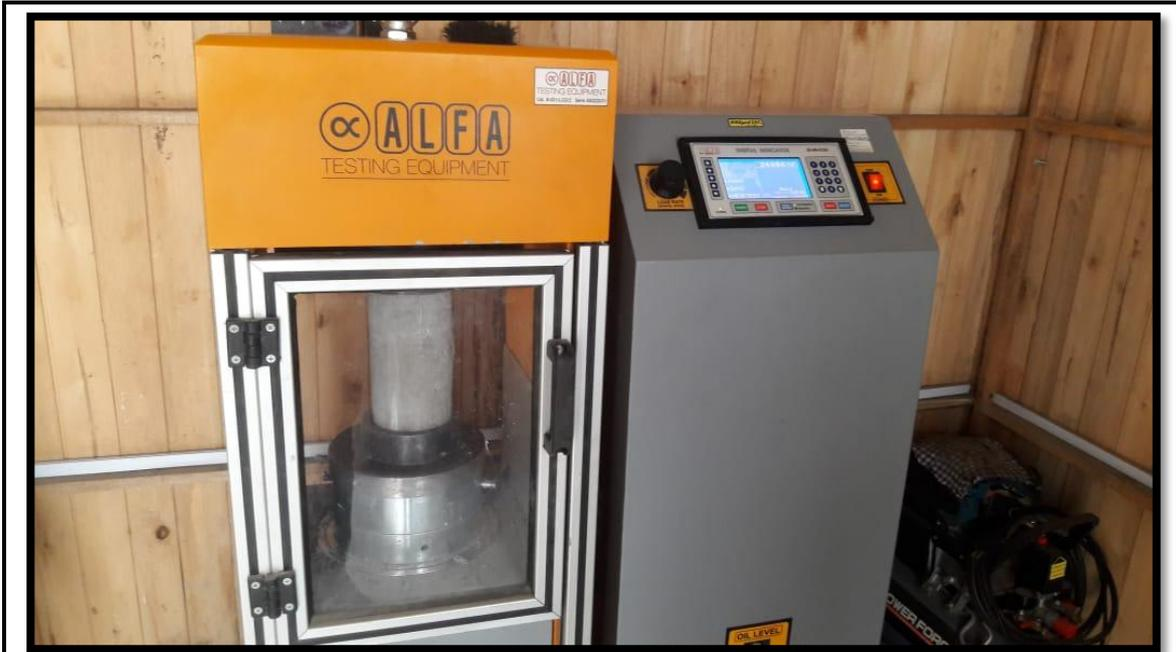
Imagen N° 05: probeta N° 06 concreto patrón a 14 días
