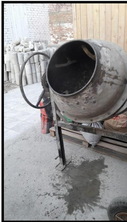
Imagen N° 07: se mantiene en funcionamiento el trompo por unos minutos
