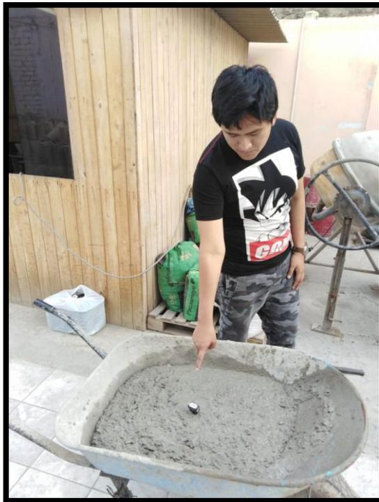
Imagen N° 09: tomamos la temperatura del concreto fresco
