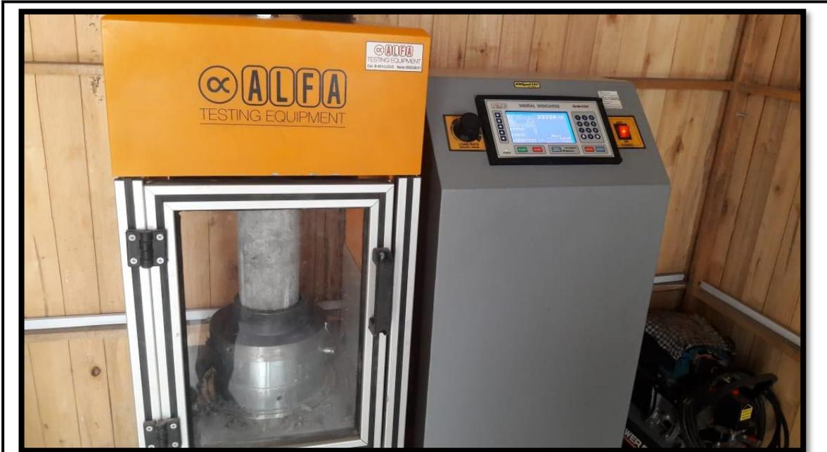
Imagen N° 03: probeta N° 05 concreto experimental a 14 días
