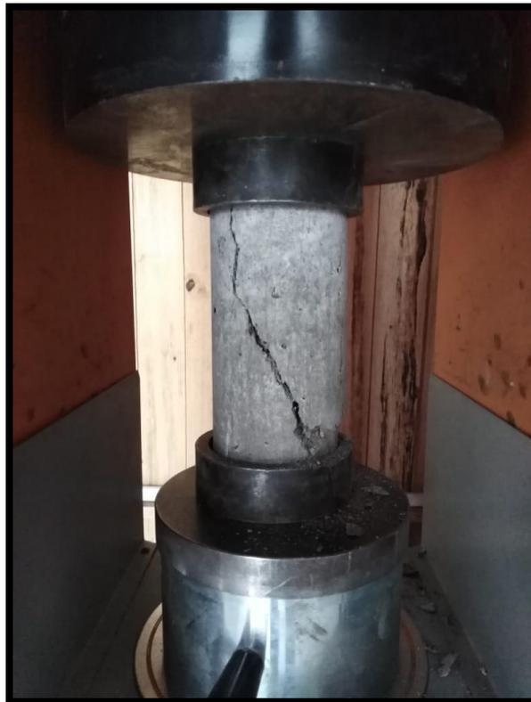
Imagen N° 03: probeta N° 02 concreto patrón a 7 días
