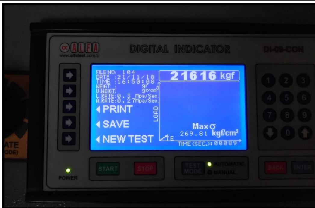
Imagen N° 06: resultado de la probeta N° 03 concreto patrón
