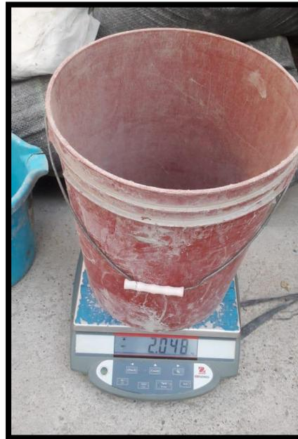
Imagen N° 01: después de tarar el recipiente pesamos el agregado grueso
