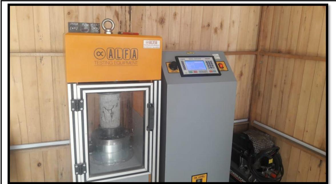
Imagen N° 03: probeta N° 08 concreto experimental a 28 días
