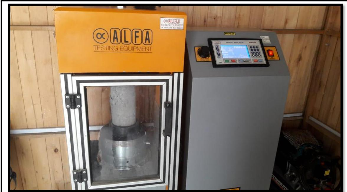
Imagen N° 03: probeta N° 05 concreto patrón a 14 días
