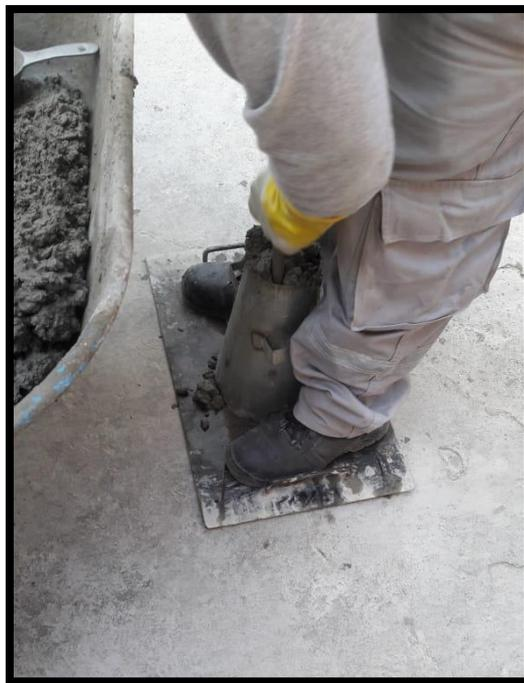
Imagen N° 10: realizamos la prueba del cono de Abram
