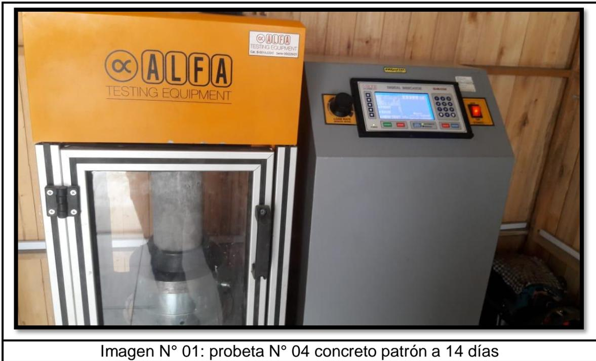
Imagen N° 01: probeta N° 04 concreto patrón a 14 días
