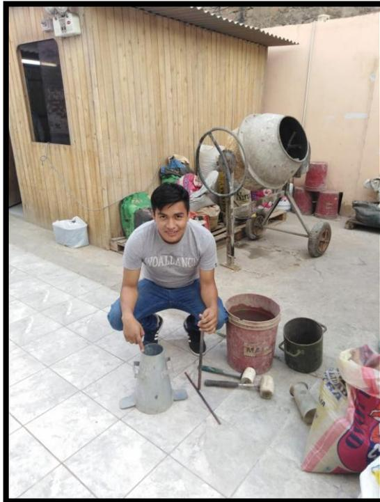
Imagen N° 09: instrumentos para realizar la prueba del cono de Abram
