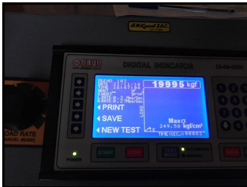
Imagen N° 04: resultado de la probeta N° 02 concreto patrón
