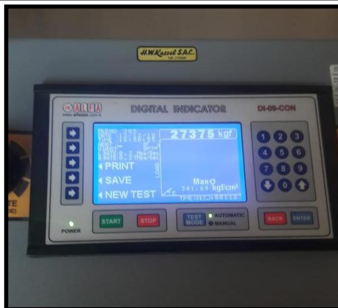
Imagen N° 04: resultado de la probeta N° 08 concreto patrón
