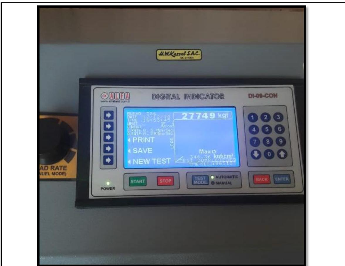
Imagen N° 06: resultado de la probeta N° 09 concreto patrón
