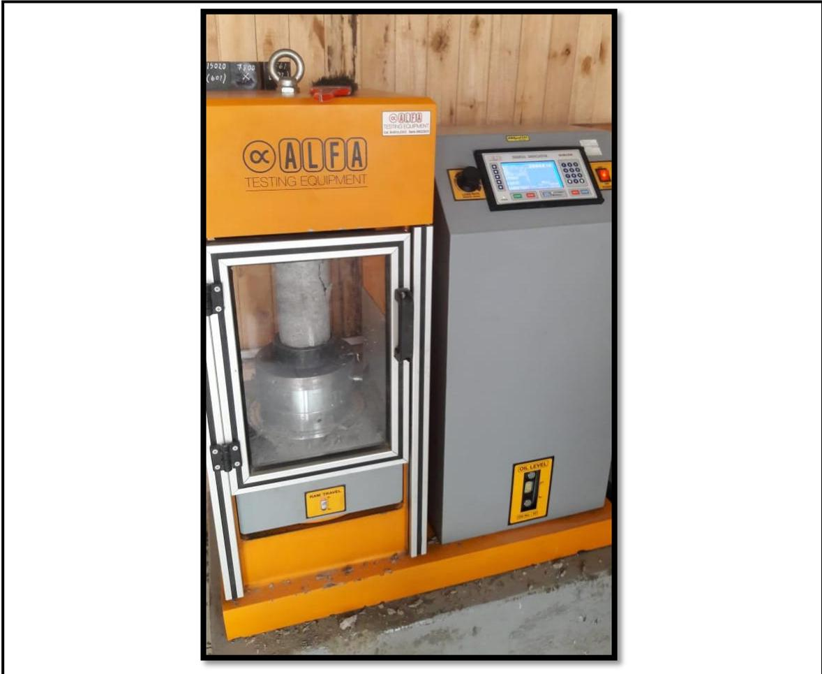
Imagen N° 05: probeta N° 06 concreto experimental a 14 días
