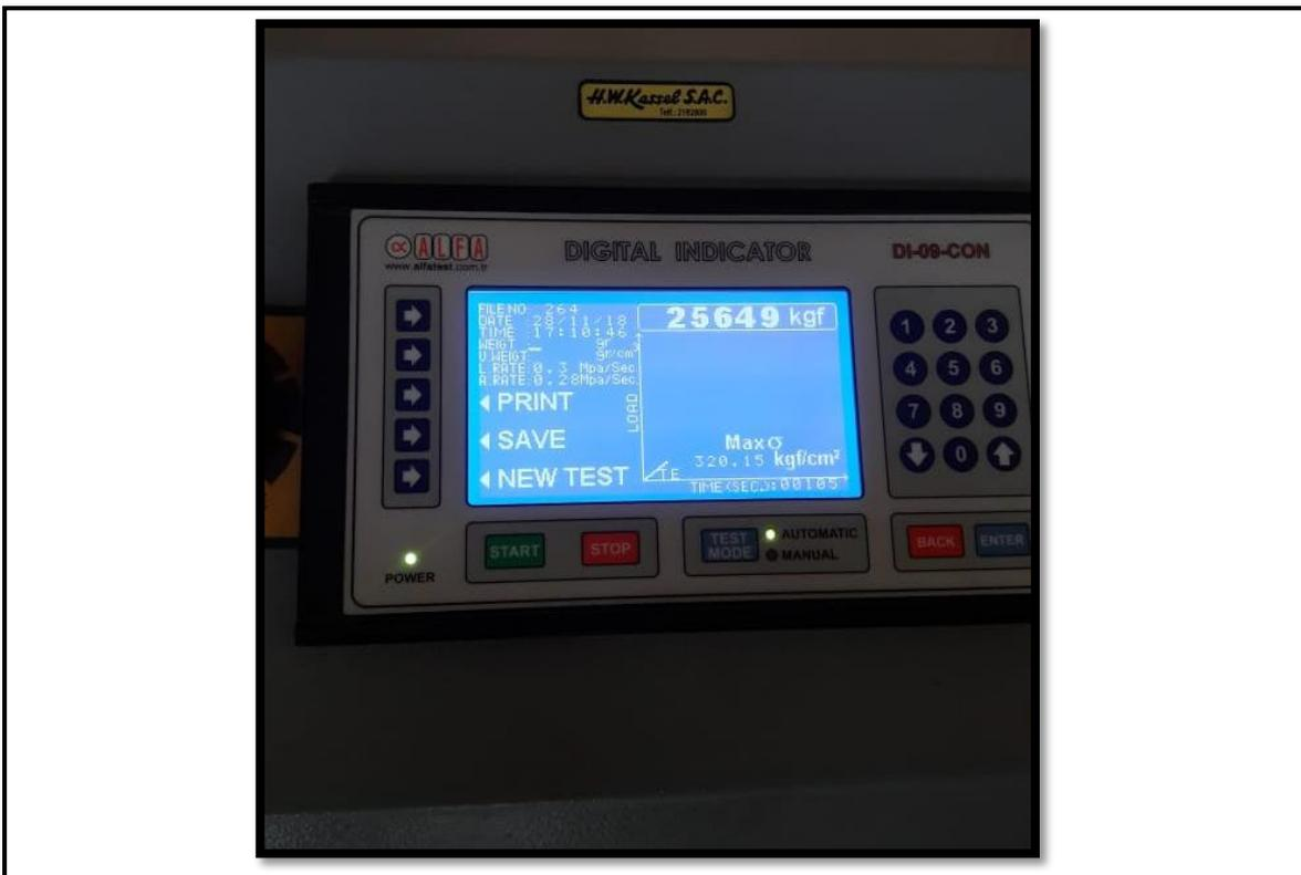
Imagen N° 04: resultado de la probeta N° 05 concreto patrón
