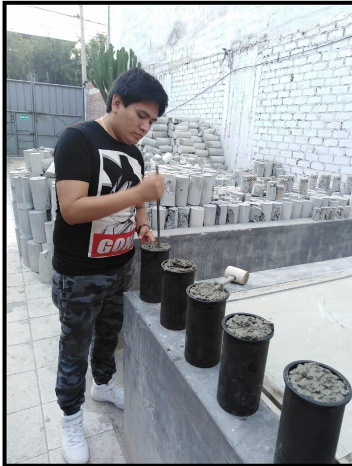
Imagen N° 12: se realiza las probetas según la norma
