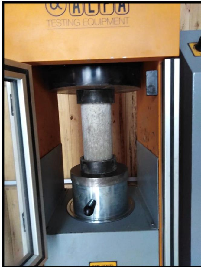
Imagen N° 05: probeta N° 03 concreto patrón a 7 días
