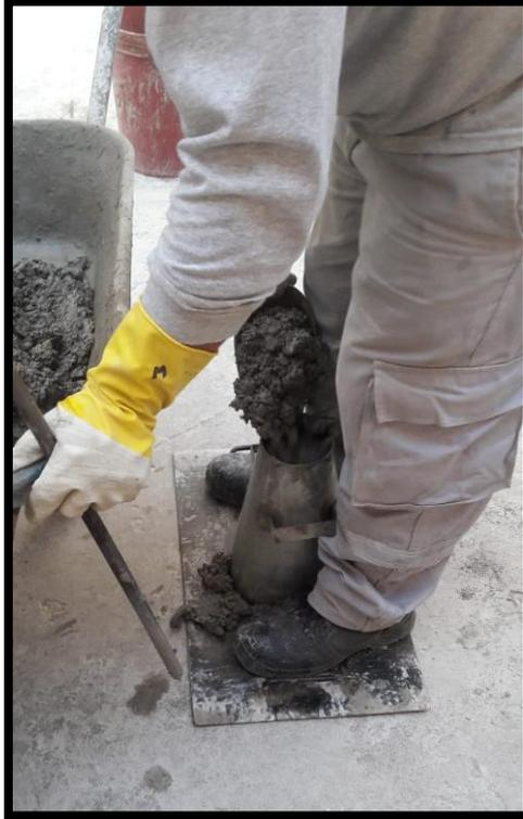
Imagen N° 10: realizamos la prueba del cono de Abram
