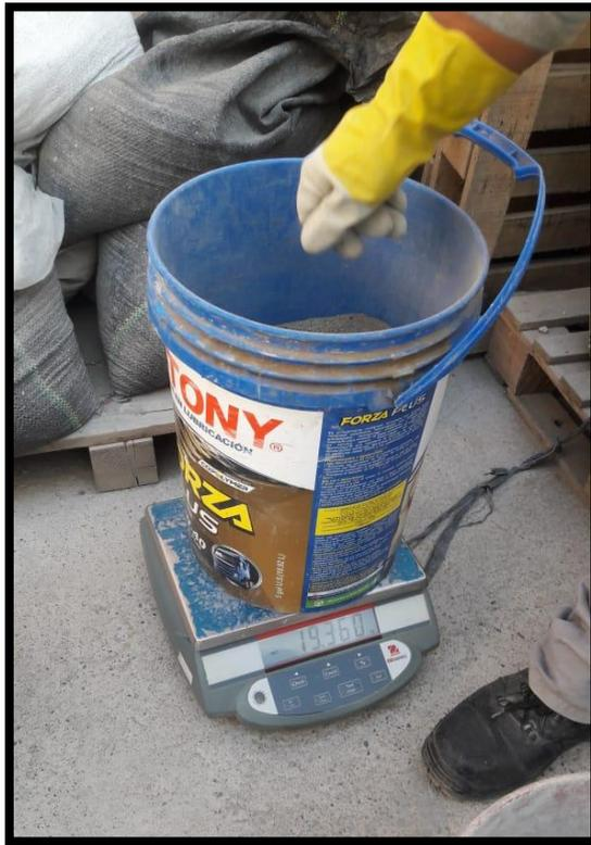
Imagen N° 01: se procede a pesar el agregado luego de tarar el recipiente
