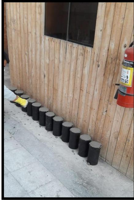
Imagen N° 13: las probetas se deja en un lugar plano durante 24 horas
