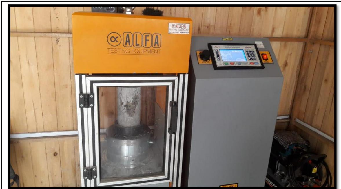
Imagen N° 01: probeta N° 04 concreto experimental a 14 días
