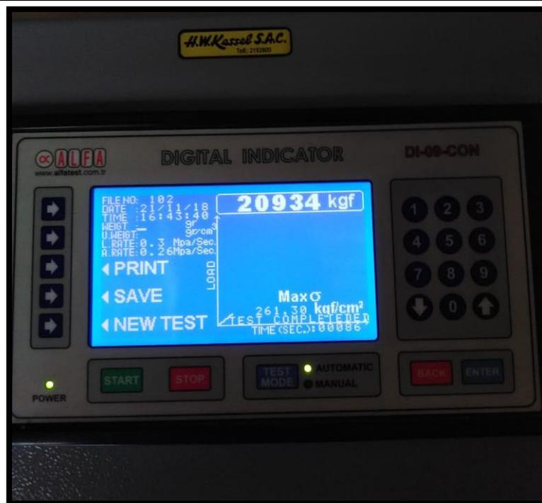
Imagen N° 02: resultado de la probeta N° 01 concreto patrón
