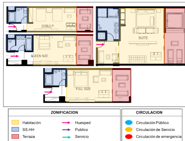
FIGURA N° 84: Planta de distribución habitaciones
