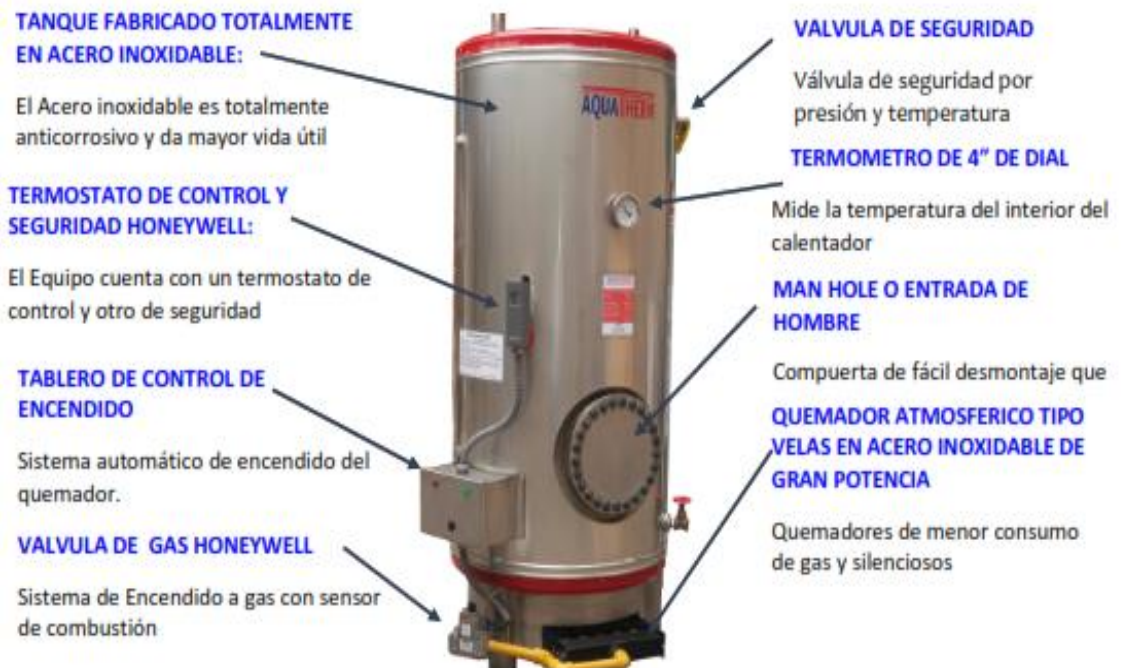
FIGURA N°104: Detalles constructivos – Termotanque AT.
