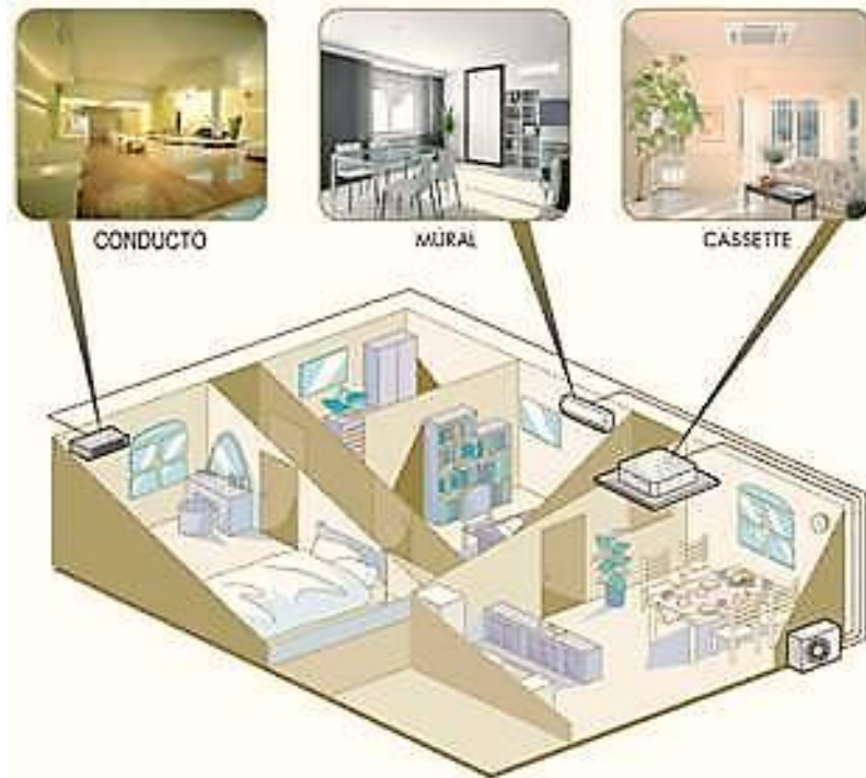
FIGURA N°120: Esquema de distribución de aire acondicionado Multi-Split
