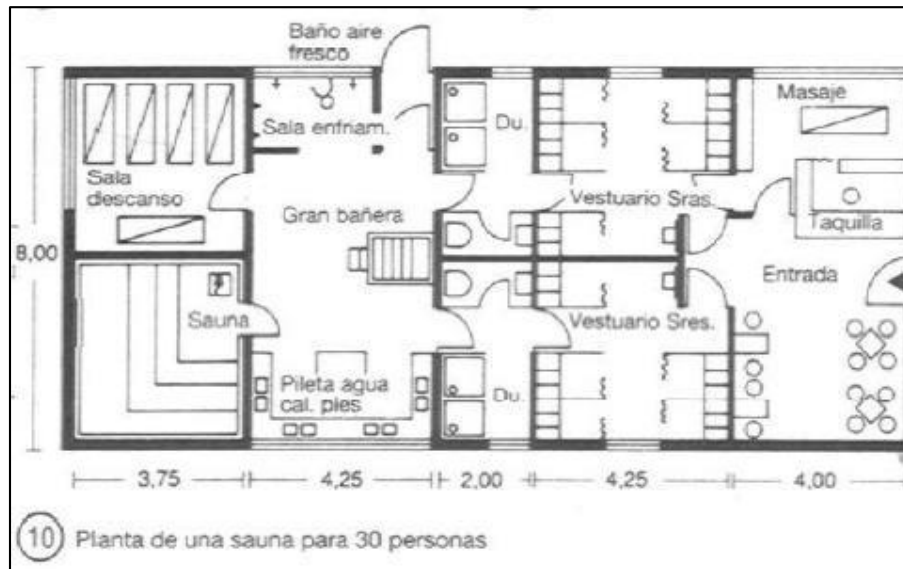
FIGURA N° 46: Plano referencial de Distribución de Sauna - Spa
