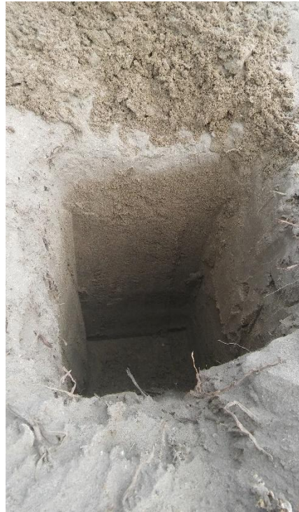
Figura 13. Calicata para observar la humedad del suelo
