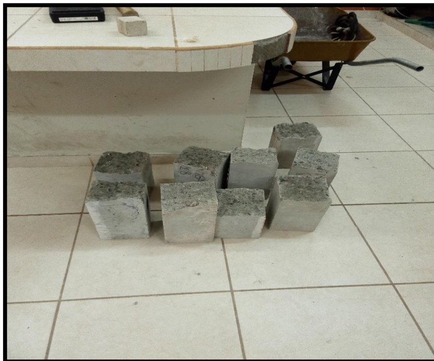
Rotura de Vigas de Concreto sin Refuerzo
