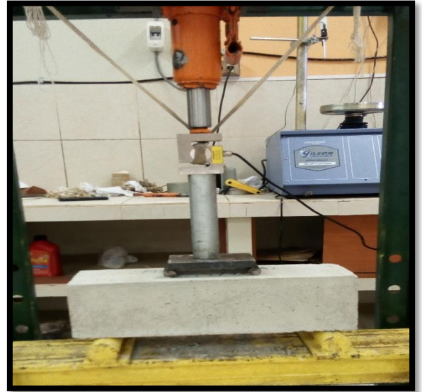
Figura N°. 24 y 25. Medidas de vigas antes de ser sometidas a flexión
