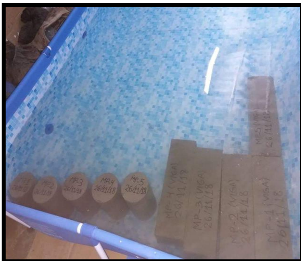
Piscina de Curado con las Vigas y Probetas Cilíndricas
