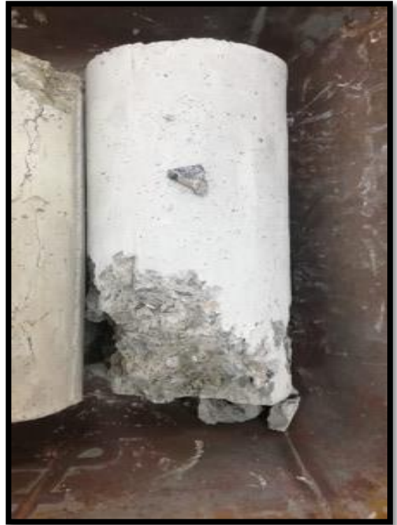
Rotura de la Probeta Cilíndrica de Concreto
