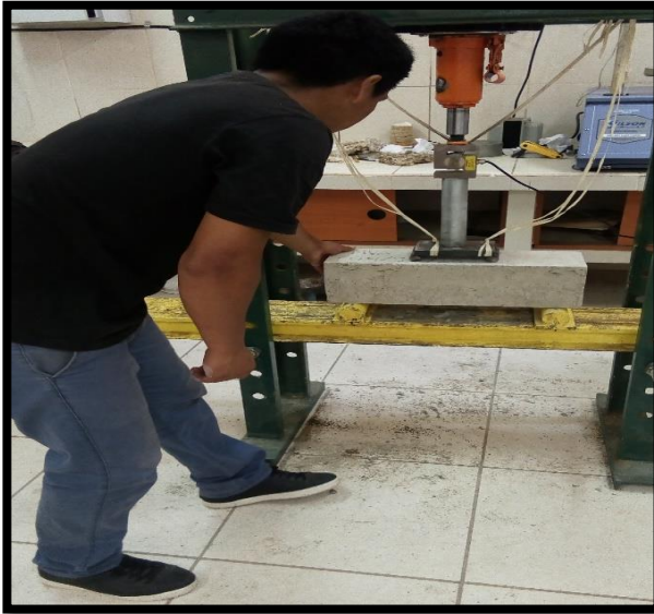
Figura N°. 24 y 25. Medidas de vigas antes de ser sometidas a flexión
