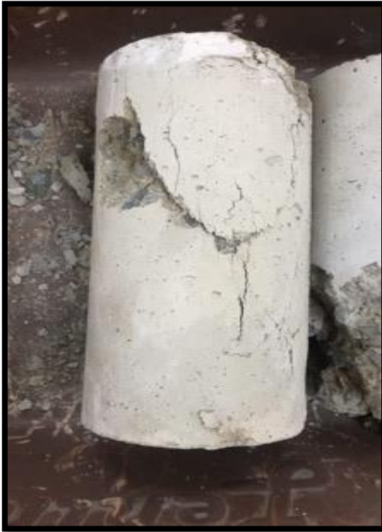
Rotura de la Probeta Cilíndrica de Concreto
