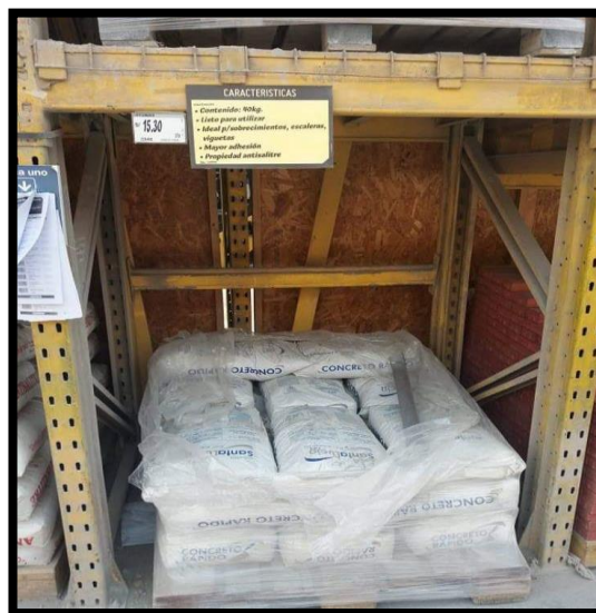
Figura N° 06. Bolsa de Concreto en Seco
