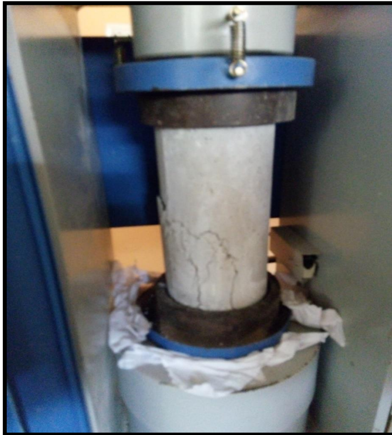
Colocación de las Probetas en la Maquina de Prueba de Compresión
