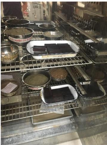
FOTO 36: Secado de probetas saturadas
