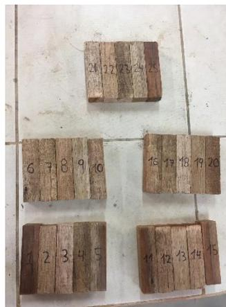
FOTO 28: Probetas de Contenido de Humedad
