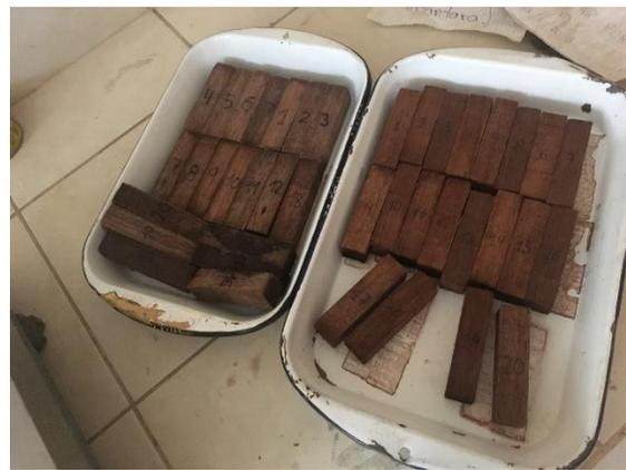
FOTO 37: Probetas de Densidad Básica secas
