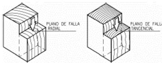
Figura 10. Probeta de Corte Paralelo. (Ordoñez G. & Lugo C., 2016, pág. 16)
