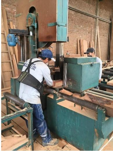
FOTO 7: Corte de listones por sección transversal
