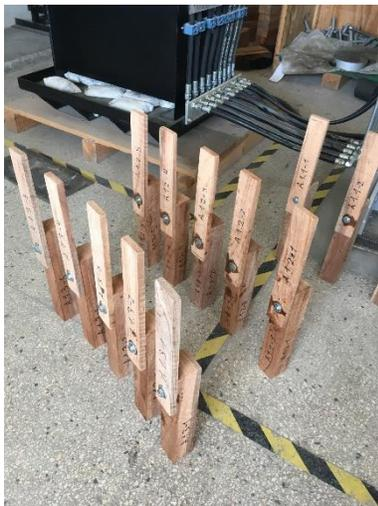
FOTO 23: Probetas de cizalla paralela
