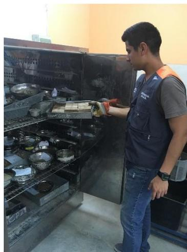
FOTO 31: Proceso de secado al horno
