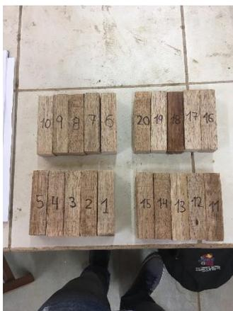
FOTO 27: Probetas de Densidad Básica
