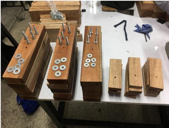
FOTO 21: Elementos de unión para cizallamiento
