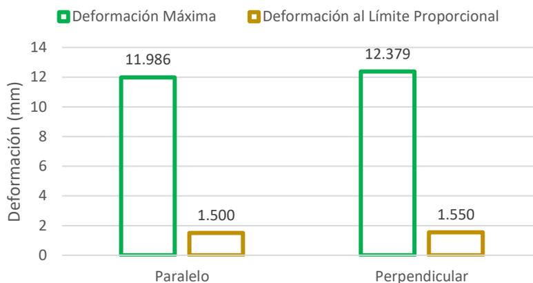
Gráfica 52. Comparativo entre Sentido de la carga respecto al grano vs Deformación máxima y Deformación al límite proporcional
