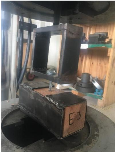
FOTO 19: Ensayo de Extracción directa
