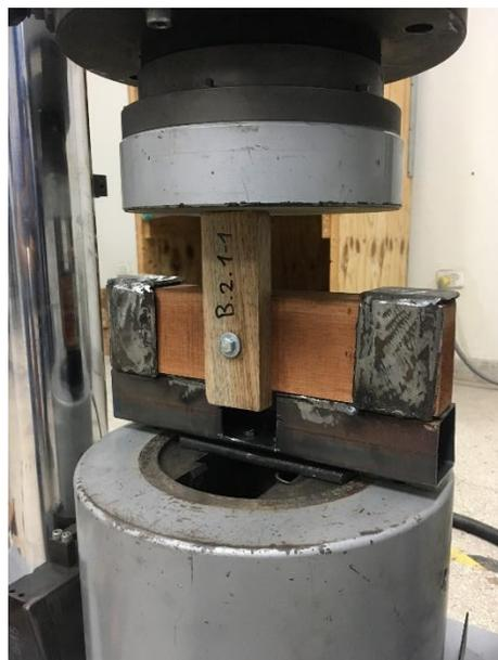
FOTO 15: Accesorio para cizalla perpendicular
