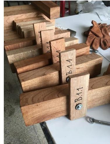
FOTO 22: Probetas de cizalla perpendicular
