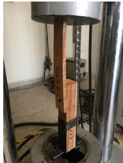
FOTO 26: Ensayo de cizallamiento paralelo
