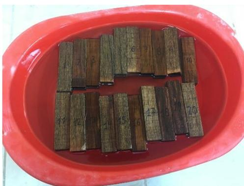
FOTO 32: Proceso de saturación de probetas
