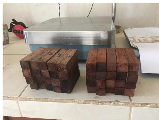
FOTO 33: Probetas saturadas
