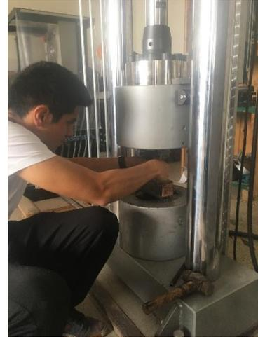
FOTO 17: Tirafones de 1/4'' para extracción FOTO 18: Preparación de probeta para extracción
