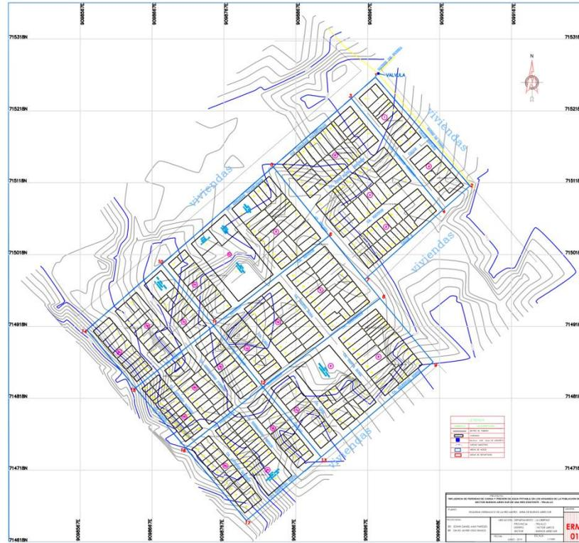
**Figura 5.** Imagen referencial del esquema hidráulico de la red matriz adjunto en los anexos
