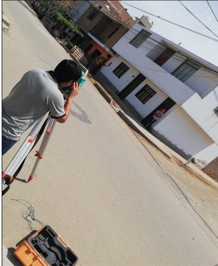
**Fotografía 3.** Tesista 1 realizando la toma de punto en el área de trabajo, Tesista 2 sosteniendo el prisma con lo cual trabaja la estación para la toma de puntos
