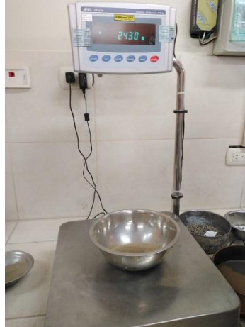
FIGURA 22- Peso de muestra retenida
