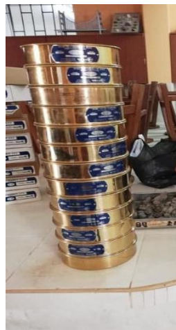
FIGURA 21 - Tamizado de las muestras
