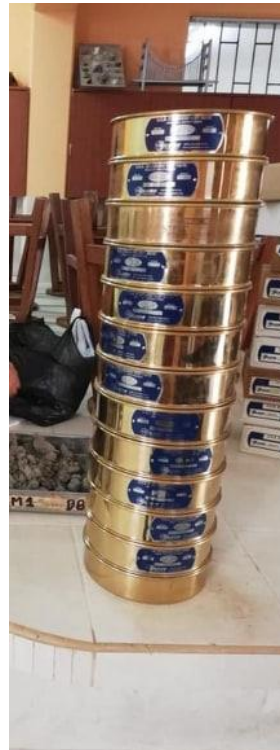
FIGURA 10 - Ensayo para obtener la granulometría del material.
