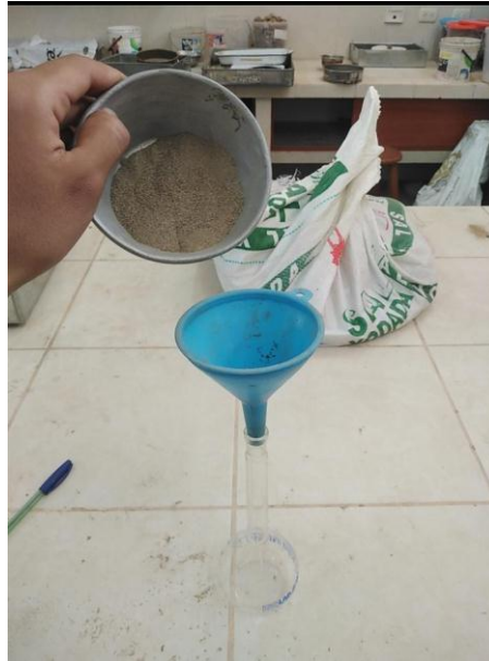
FIGURA 24 - Ensayo para Peso específico
