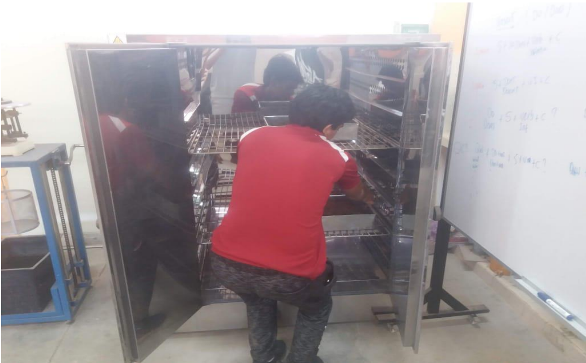
FIGURA 8 - Muestra puesta al horno a una temperatura de 200\text{ }^{\circ}\text{C} , en un tiempo estimado de 18 a 24 horas.
