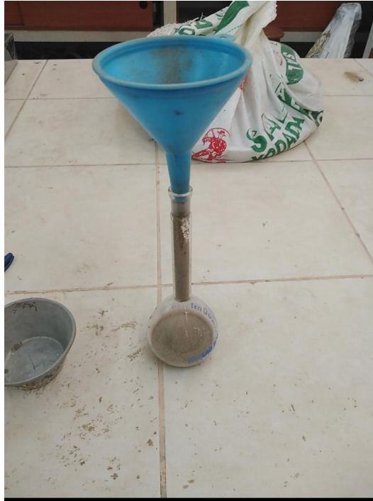
FIGURA 26 – Ingreso de la muestra en el Picnómetro Fuente: Autoría Propia
