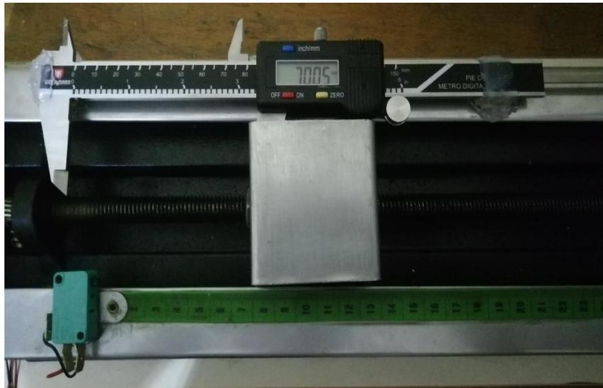
**Figura 25.** Vernier digital sobre articulación lineal.
