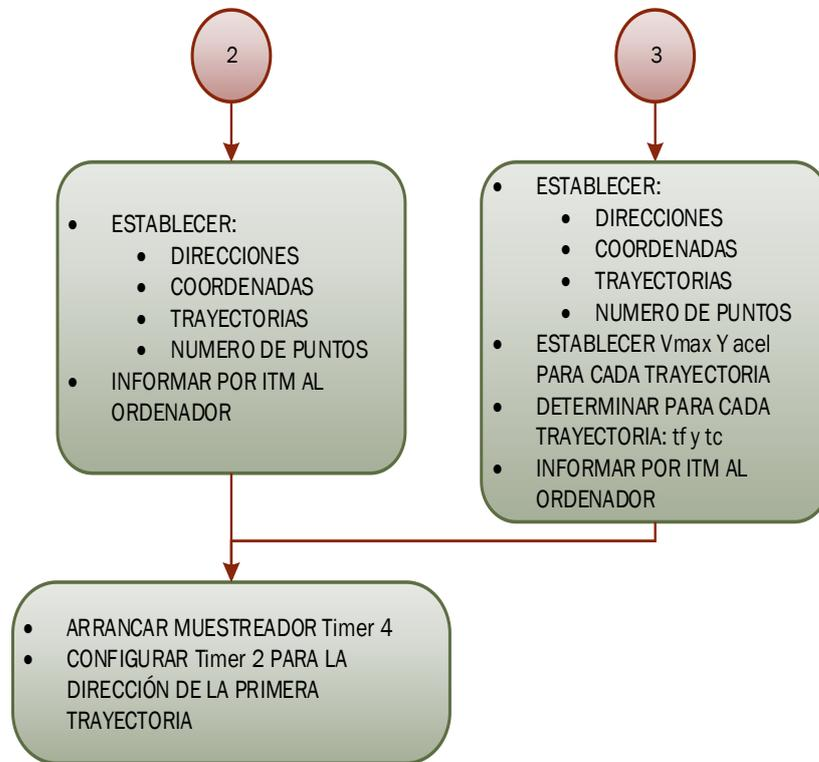
**Figura 33.** Diagrama de flujo del manejo de la orden “sp=[coor1],[coor2]..”, para el control PID discreto y el algoritmo Trapezoide - PID.
