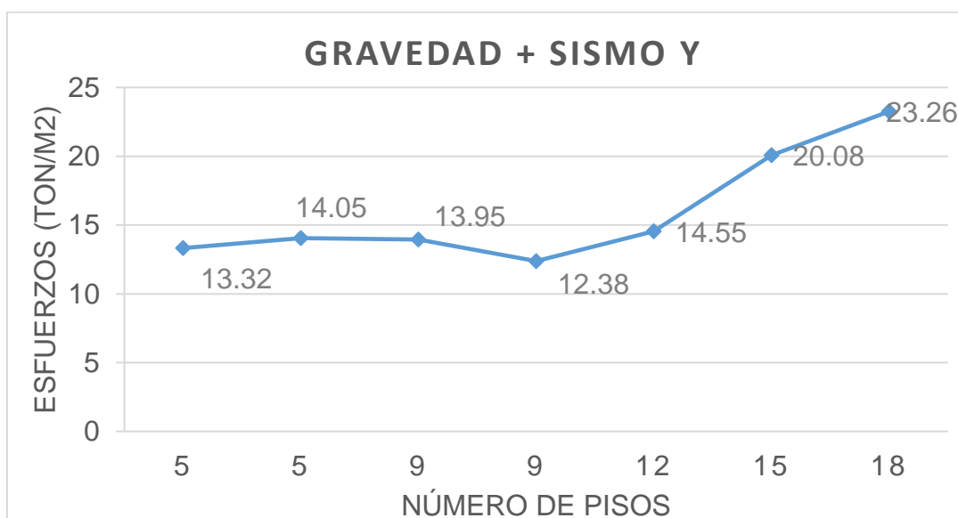
Figura N° 4. 49. Gráfico esfuerzos vs número de pisos para estado de cargas de gravedad + sismo x
