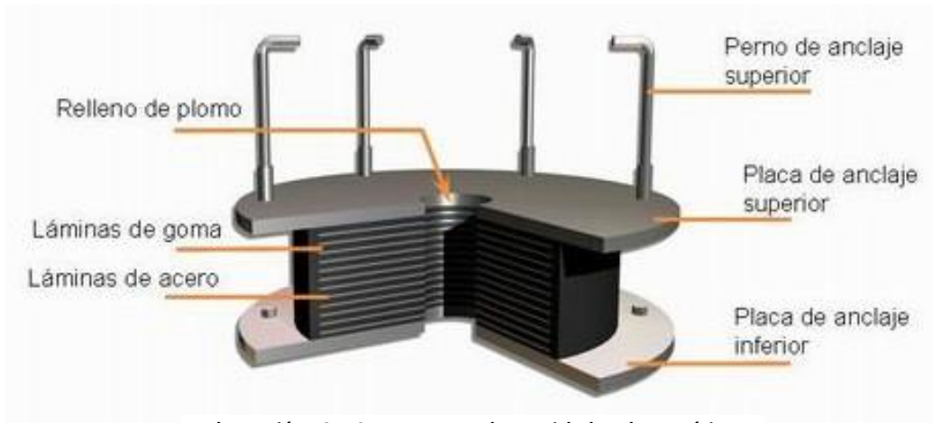
Ilustración 104: Componentes de un Aislador Elastomérico
