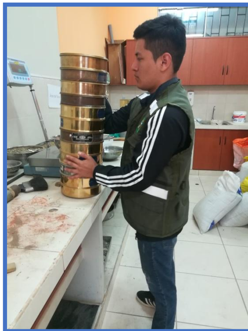
Imagen N° 16: Colocación de la Muestra y proceso de Tamizado
