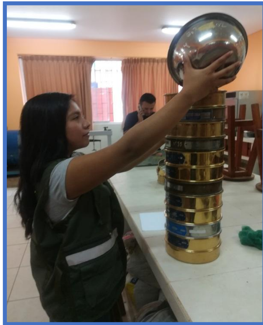
Imagen N° 15: Colocación de la Muestra y proceso de Tamizado
