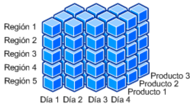
Ilustración 8. Cubo OLAP y sus dimensiones
