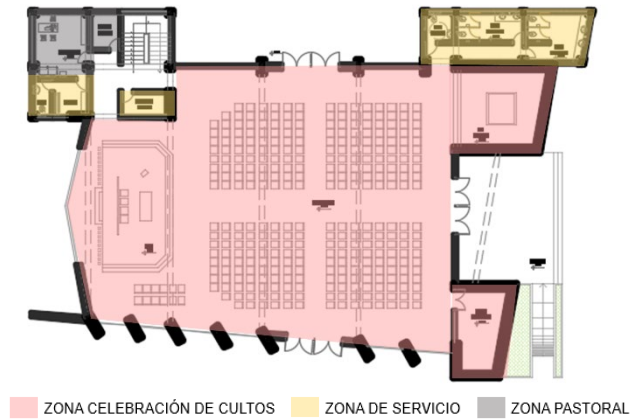
Figura N.º 60 Planta de distribución del templo
