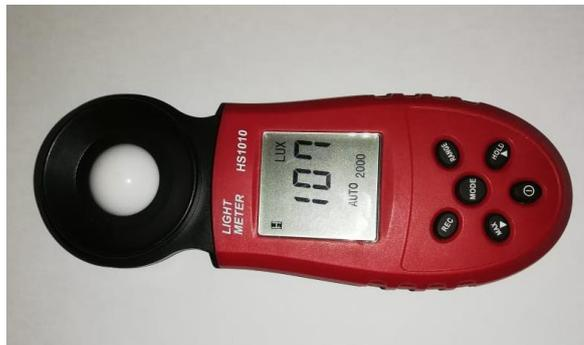
Figura 19 *Luxómetro empleado una medida del nivel de iluminación.*
