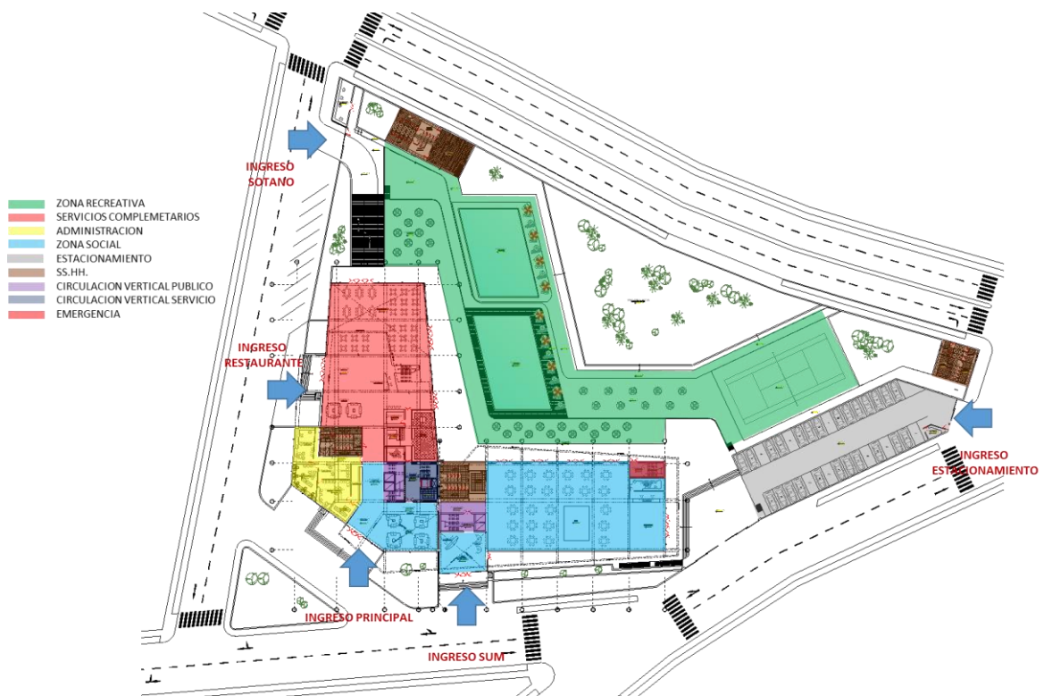
Imagen N° 21: Zonificación planta de Primer Nivel Fuente: Elaboración Propia
