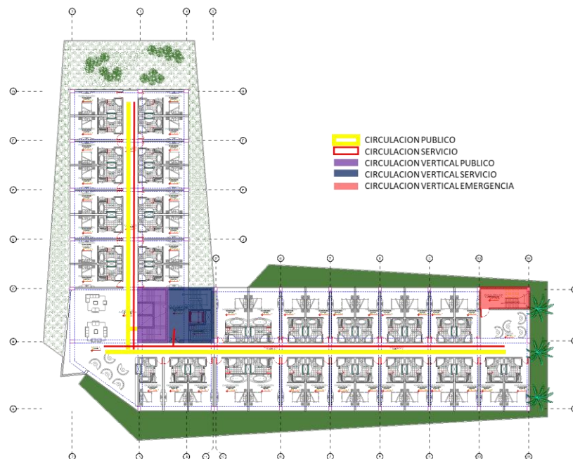
Imagen N°29: Circulación y flujos planta de Cuarto – Octavo Nivel Fuente: Elaboración Propia
