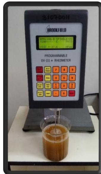
Figura H. Medición de viscosidad aparente
