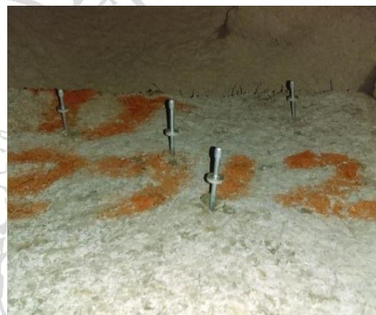
**Imagen 45:** Medición de la resistencia temprana del Shotcrete. (Método B)
