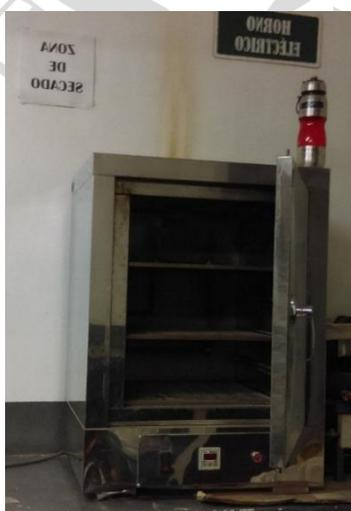
Imagen 31: Horno de capacidad de mantener temperatura a  $110^{\circ}\text{C} \pm 5$
