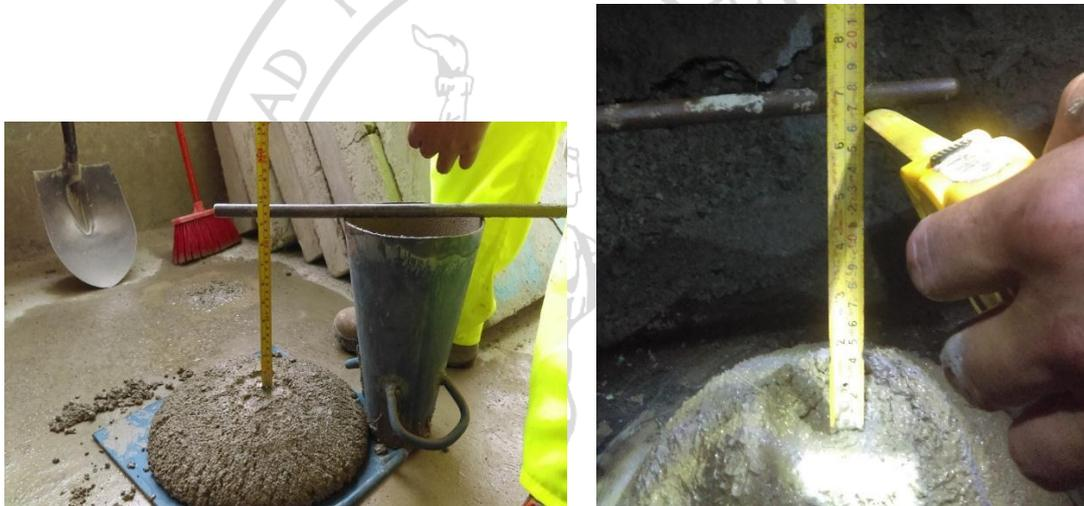
Imagen 34: Prueba de slump Laboratorio y Campo (frente de labor)
