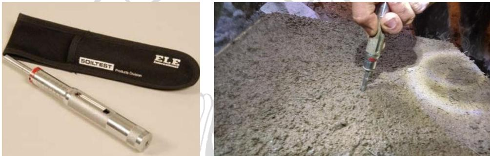
**Imagen 41:** Para evaluar el comportamiento de la fragua inicial (500lb/pulg<sup>2</sup>)
