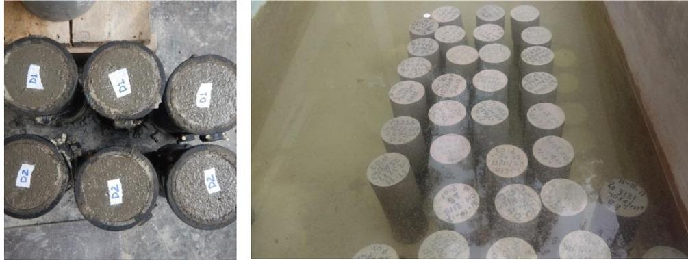
**Imagen 36:** Testigos cilíndrico en moldes de 4X8”
