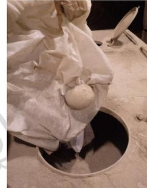
*Imagen 2: Cemento con poca frescura de fabricación.*
