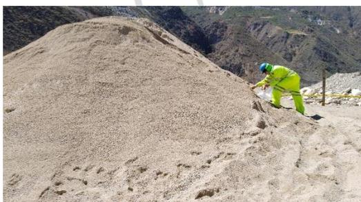
*Imagen 16: Muestreo de material árido procesado.
