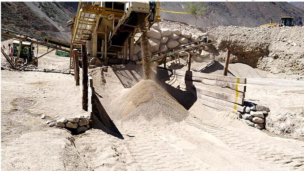
*Imagen 8: Planta de zarandeo y producción de arena para Shotcrete.*
