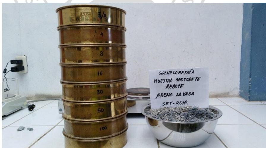
**Imagen 29:** Ensayo granulométrico de material rebote lavado
