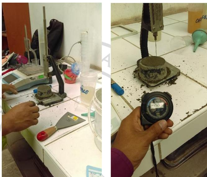
**Imagen 33:** Evaluación del comportamiento de fragua del cemento
