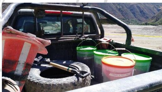
*Imagen 17: Traslado de material árido muestreado en recipientes no absorbente.
