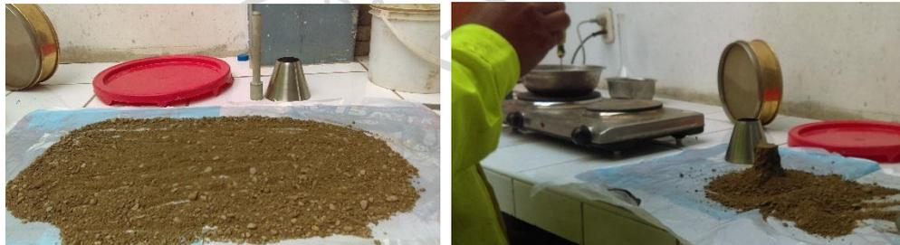
Imagen 34: Prueba de la condición del árido SSS
