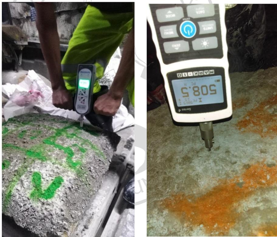
**Imagen 44:** Medición resistencia inicial del Shotcrete con Penetrometro Digital ( Método A)
