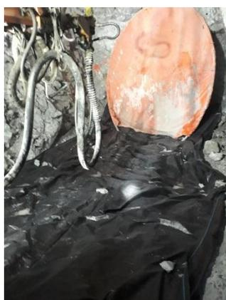
*Imagen 18: (1) Tendido lona de nylon para recolección de muestra material rebote
