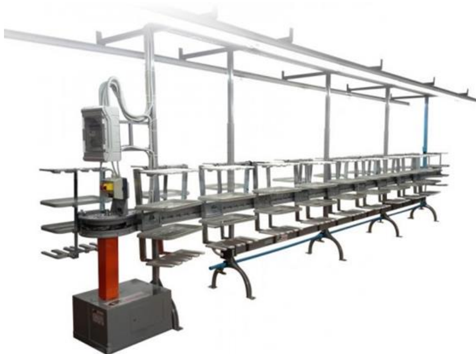
Figura 18. Transportador Motorizado de Cinta Plana. Fuente: Anzani Machinery S.R.L.
