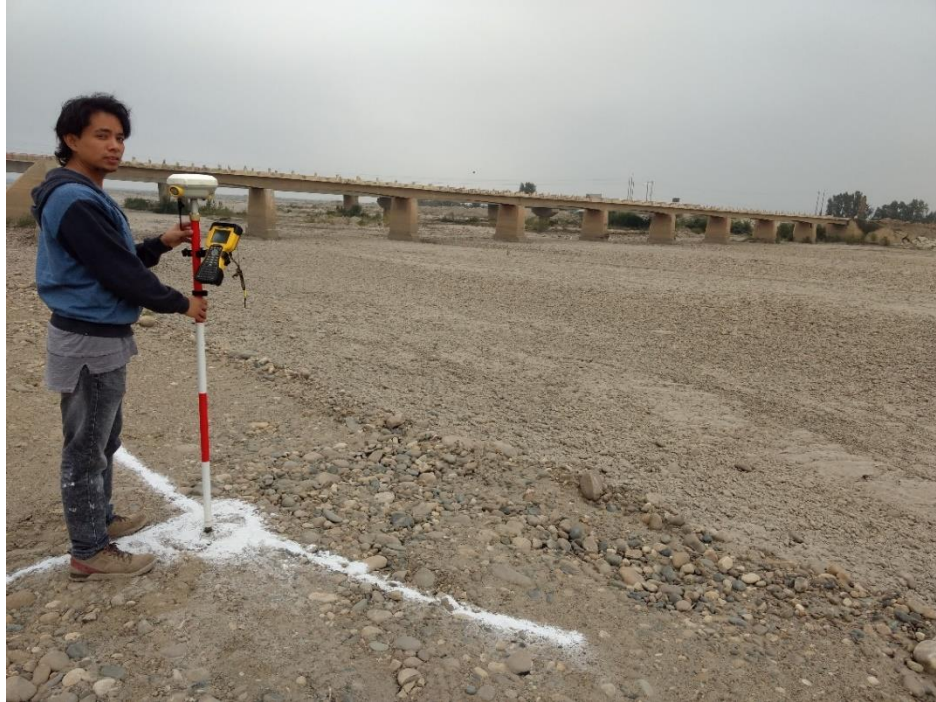
Figura 6. Punto tomado con GPS diferencial para complemento del levantamiento topográfico con drone.
