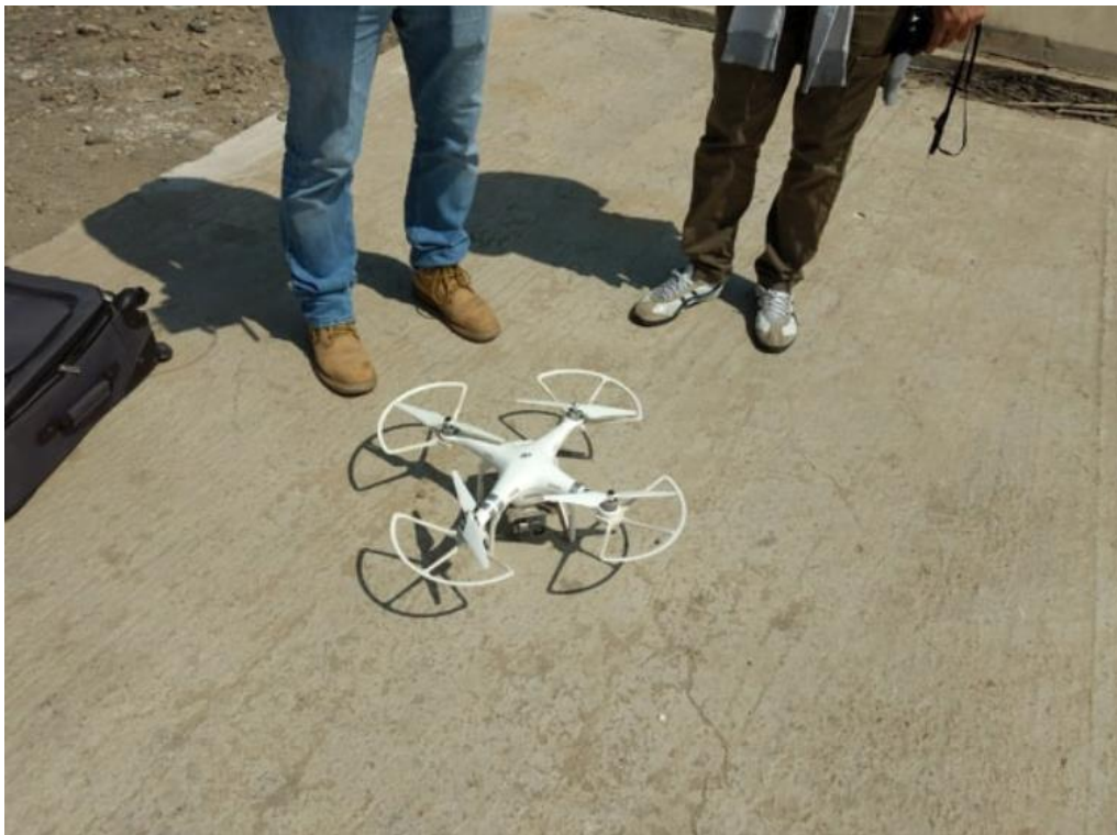
Figura 5. Dron utilizado para el levantamiento topográfico.
