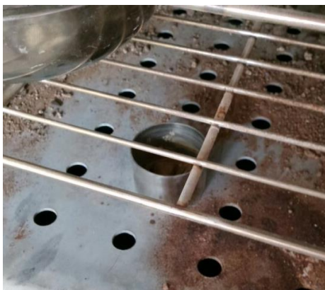
Foto 13 – Secado en horno de los hilos de 3.2 mm
