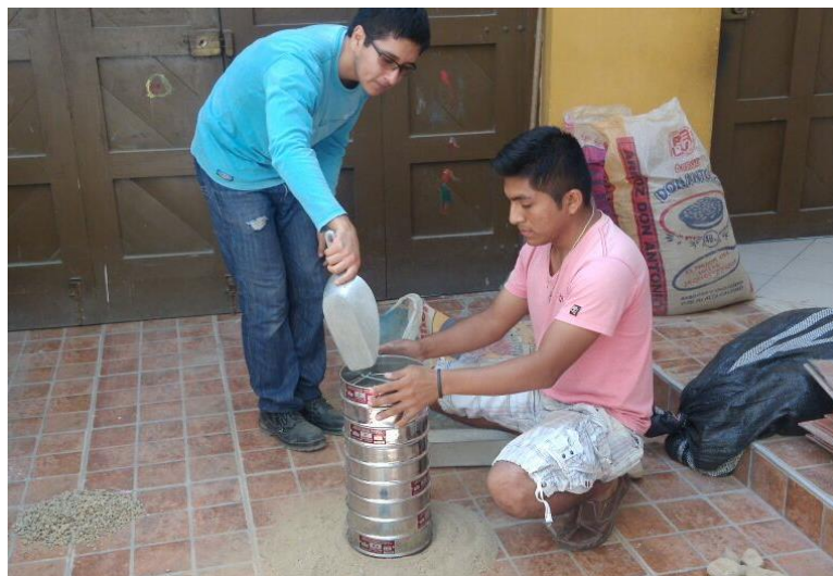
Foto 09 – Tamizado de la muestra utilizando las mallas 2", 1 1/2", 1", 3/4", 3/8", N°4
