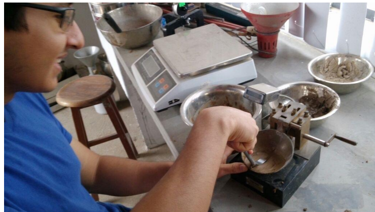
Foto 09 – Ranurado de la muestra (espesor 12.7 mm).
