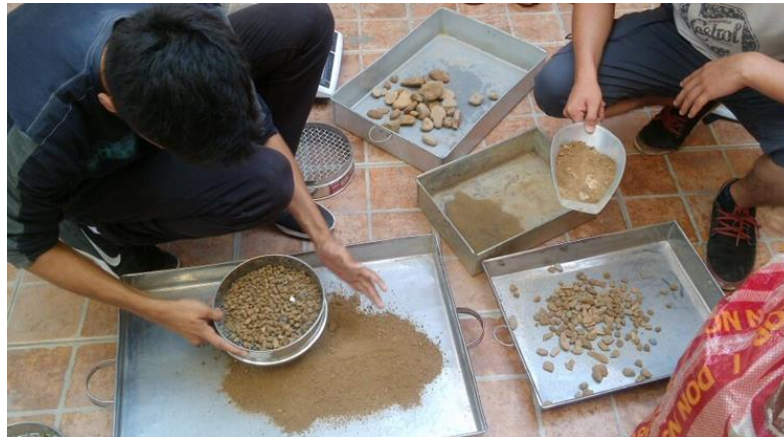
Foto 14 – Tamizado de muestra con las mallas n° 4, 3/4” y 3/8”
