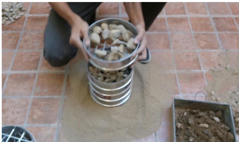
Foto 10 – Tamizado de la muestra utilizando las mallas 2”, 1 ½”, 1”, ¾”, 3/8”, N°4
