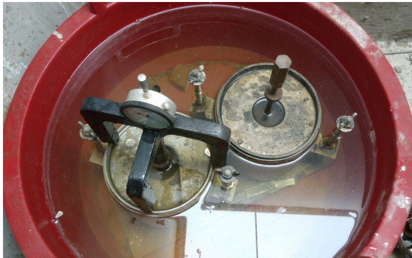
Foto 17 – Saturación de la muestra por 96 horas junto al deformímetro
