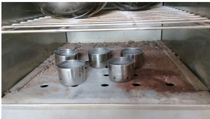
Foto 11 – Secado de muestras en el horno a 110°C
