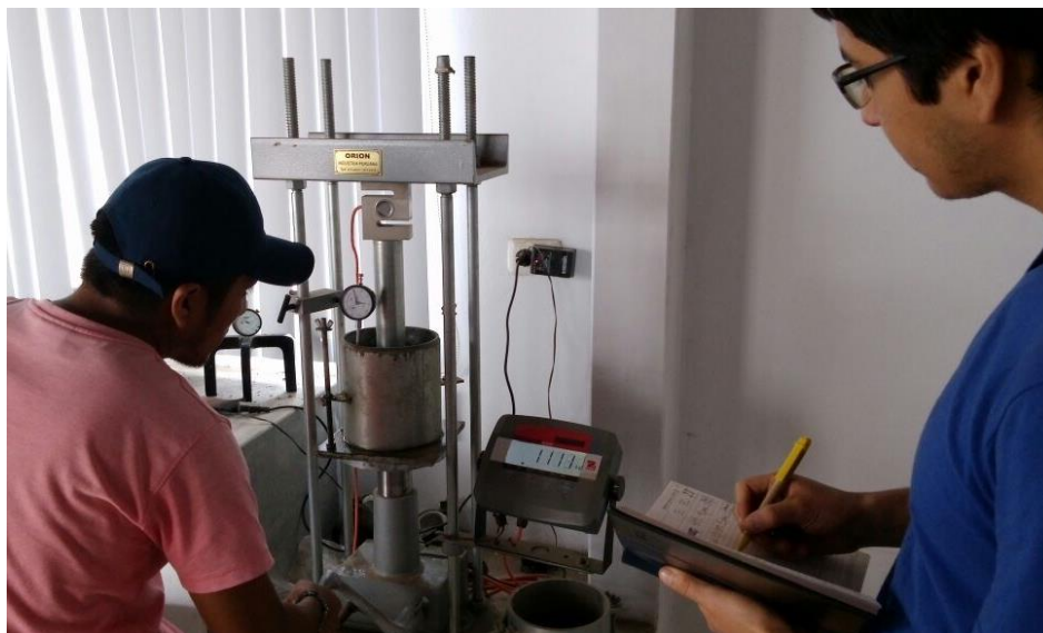
Foto 18 – Penetración de la muestra a una velocidad uniforme de 1.27 milímetros por minuto
