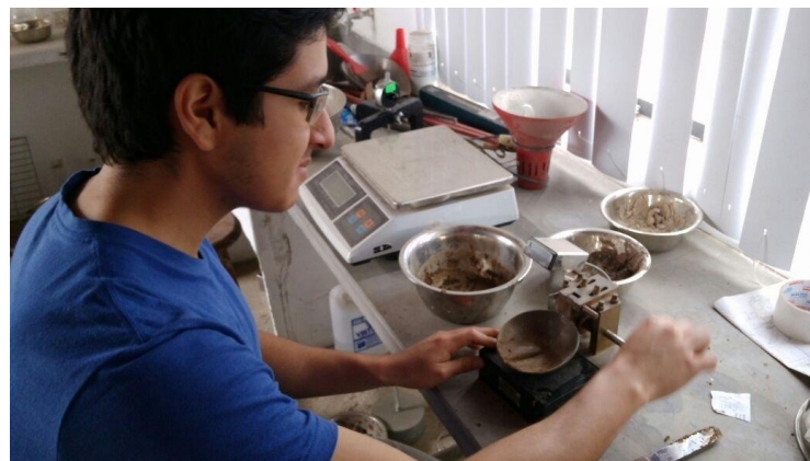
Foto 10 – Ejecución de golpes hasta que cierre la ranura
