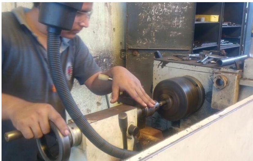
Foto 04 – Fabricación del cabezal de 60° en torno.
