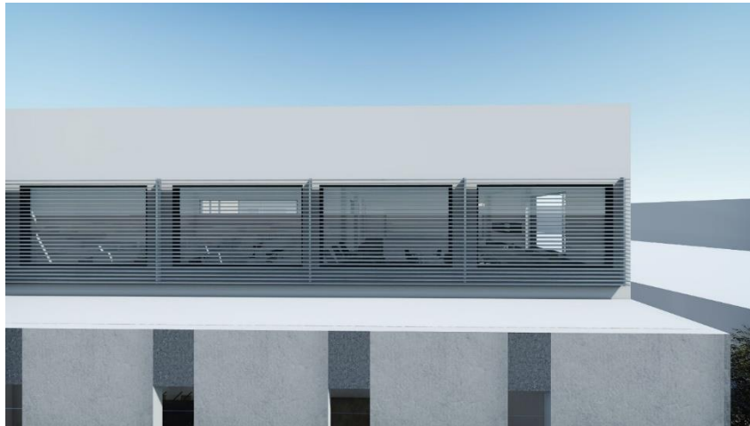
IMAGEN N° 069: Lamas de aluminio fijas Fuente: Elaboración Propia
