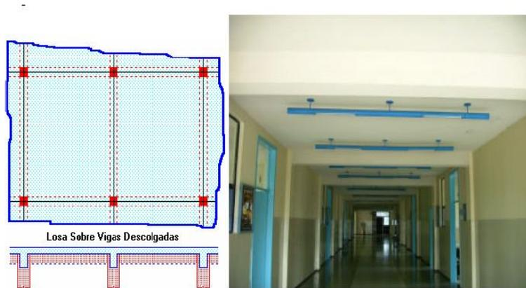
Imagen N°48: Losas Sustentadas sobre Vigas
