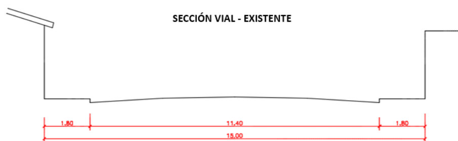
IMAGEN N°15: Sección de Vía existente
