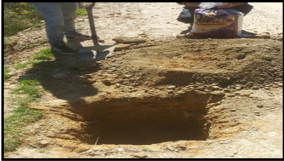
Fotografía 08: Excavación de la calita N° 08 y toma de muestra.
