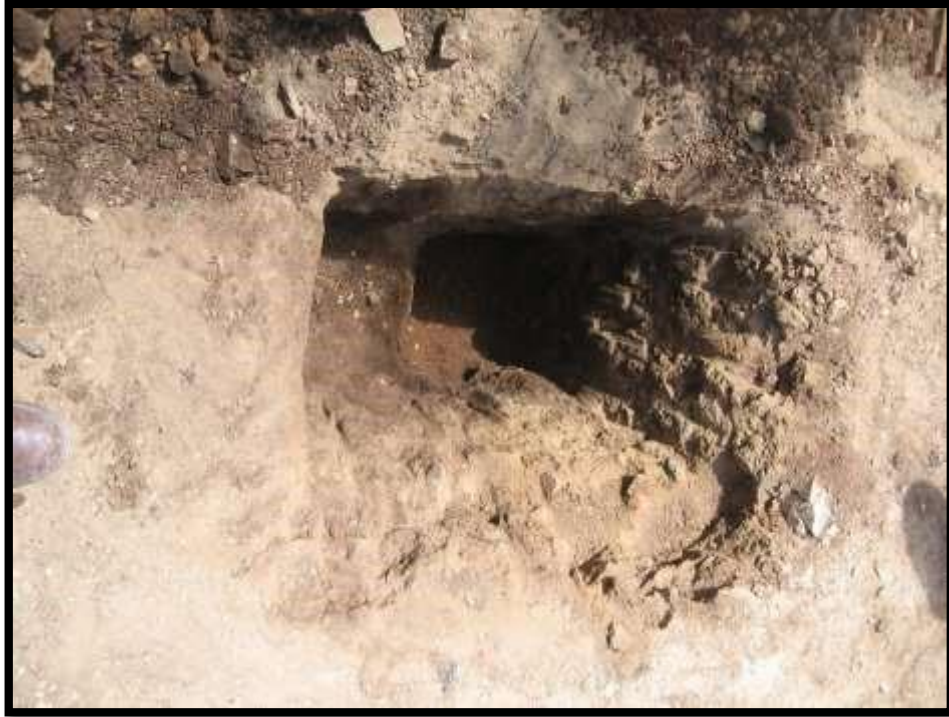
Fotografía 03: Excavación de la calita N° 02 y toma de muestra.
