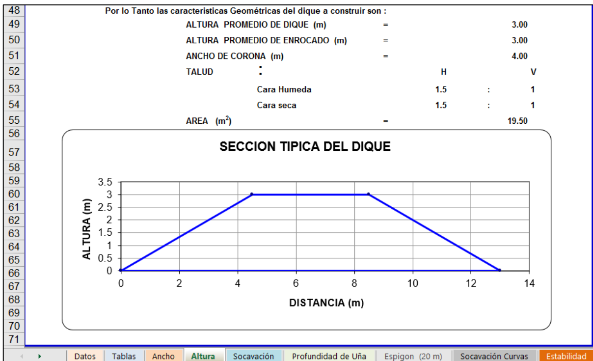
Fig. 72 Sección Típica del Dique Fuente: Propia
