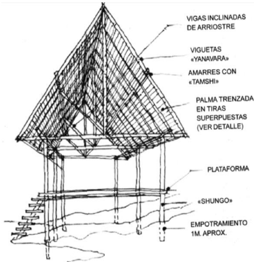
Imagen 29. Sistema constructivo, estructura de troncos rollizos, techos de palma
