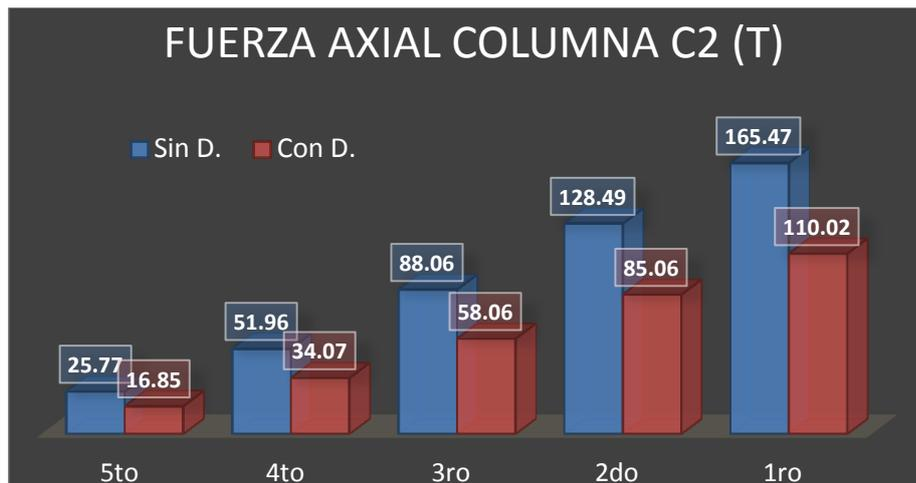
Fig. 111 Fuerza axial máxima en cada nivel para la Columna C2
