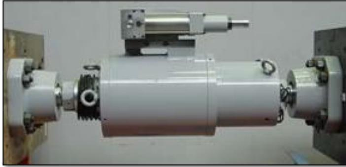
Fig. 25 Disipador viscoso HiDAX-e
