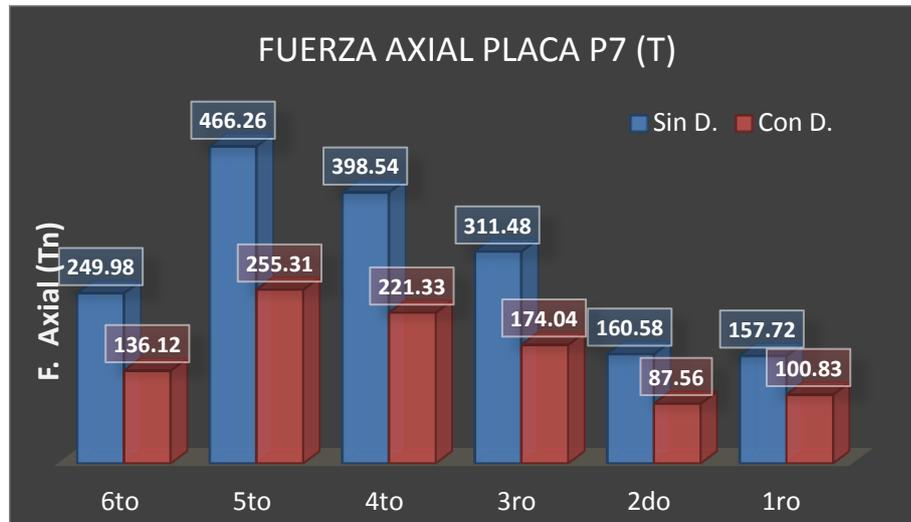
Fig. 116 Fuerza axial máxima en cada nivel para la Placa P7
