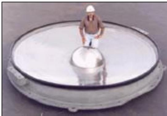
Fig.9 Aislador de péndulo friccional
