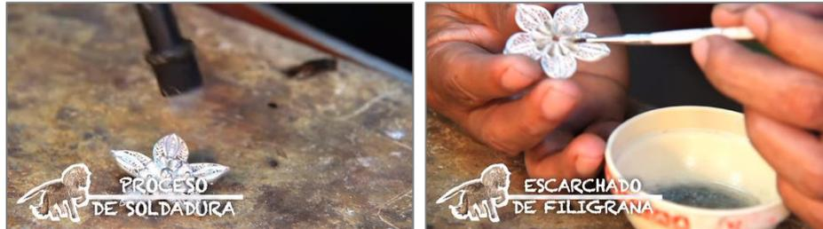
Los pasos finales incluyen soldar los accesorios de relleno juntamente con la pieza y luego escarchar la pieza final con polvo de metal que puede ser de plata o cobre.
