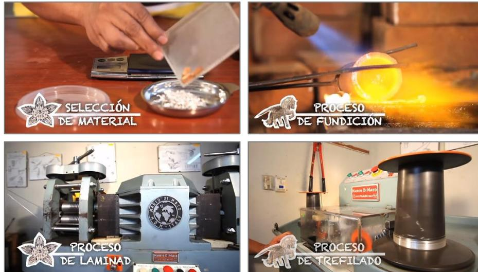
En los primeros pasos, se selecciona la plata 999 y cobre en porcentajes de 90 a 10 respectivamente, ambos metales pasan juntos al proceso de fundición. El metal se vierte en un lingote de hierro donde se solidifica, para pasar a la prensadora y ser laminado formando un hilo a un calibre de 1.30 La máquina de trefilado permite pasar el hilo de calibre 1.30 a un calibre de 0.28 usando unos discos de diamante en el proceso y un baño permanente de agua.
