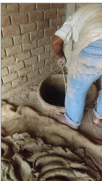
Una vez que secó la arcilla, se la coloca en recipientes semienterrados para agregarle a cada tres partes de arcilla, una parte de agua con una parte de arena y formar una pasta maleable.
