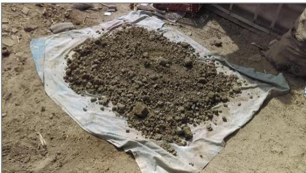
Luego de la extracción de la arcilla en el poblado de La Legua, se procede a secarla exponiéndola al sol sobre mantas impermeables. Esto permitirá eliminar todo rastro de humedad que altere la composición pastosa útil para la elaboración de artesanías.
