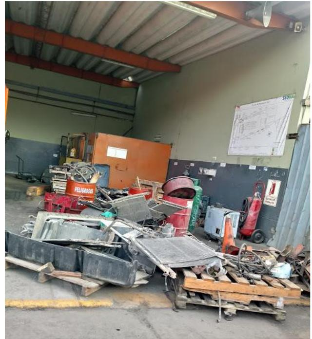
*Figura 25.* Elementos Innecesarios en el área de mantenimiento. La figura muestra planchas metálicas en deterioro, bandejas rotas, fierros, alambres viejos y mangueras.
