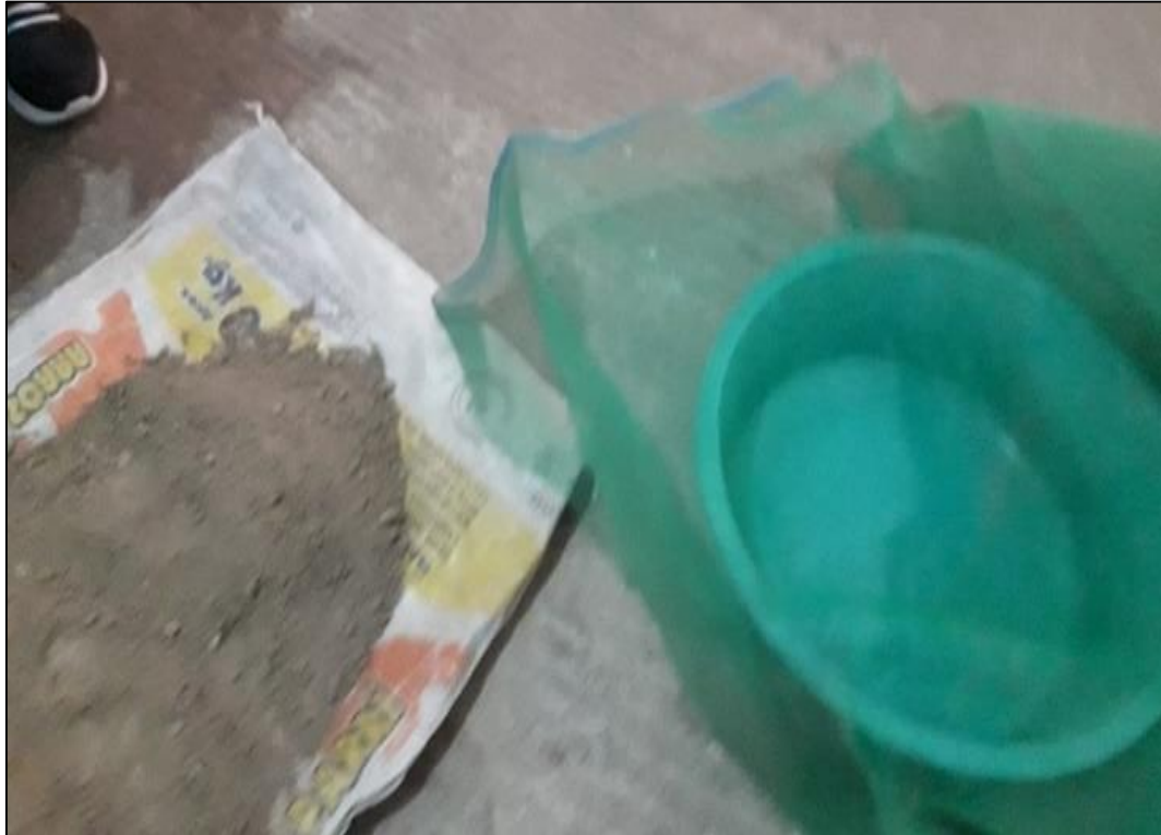
Foto N° 05: Tamizando el material en malla N° 16. Fuente: Autoría Propia.
