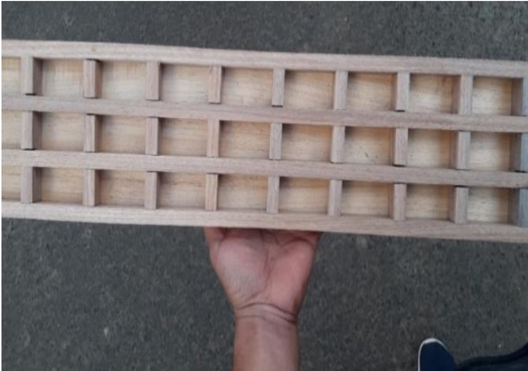
Foto N° 02: Molde para unidades de albañilería. Fuente: Autoría propia.
