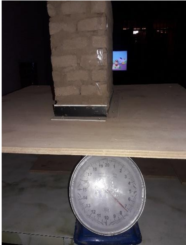
Foto N° 19: Obteniendo el peso del muro y con Polietileno indicado en la muestra M-1. Fuente: Autoría propia.
