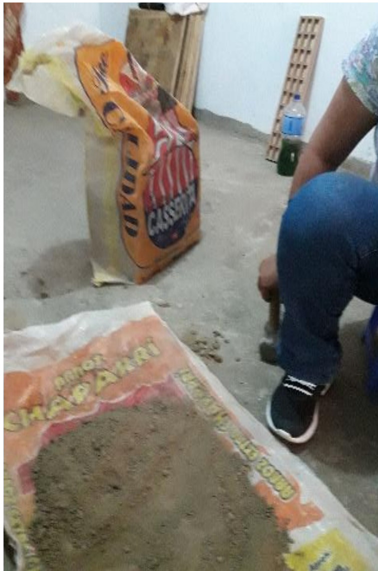
Foto N° 04: Triturando el adobe para obtener el material a usar Fuente: Autoría Propia.
