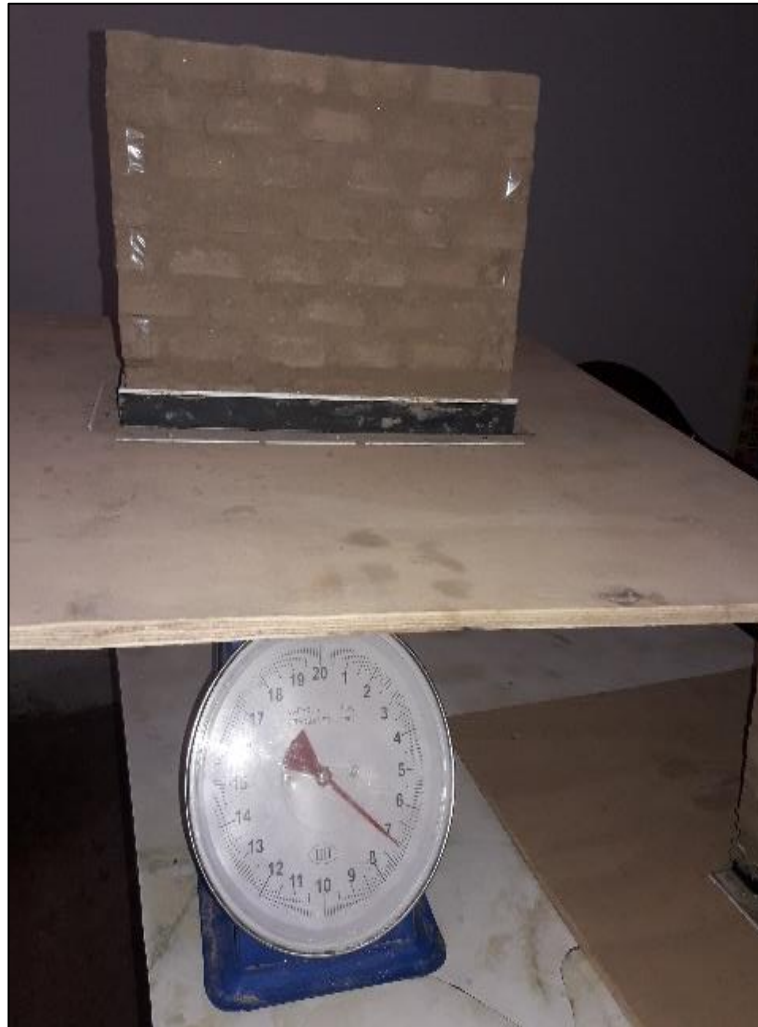
Foto N° 18: Obteniendo el peso del muro y con Polietileno indicado en la muestra M-3. Fuente: Autoría propia.
