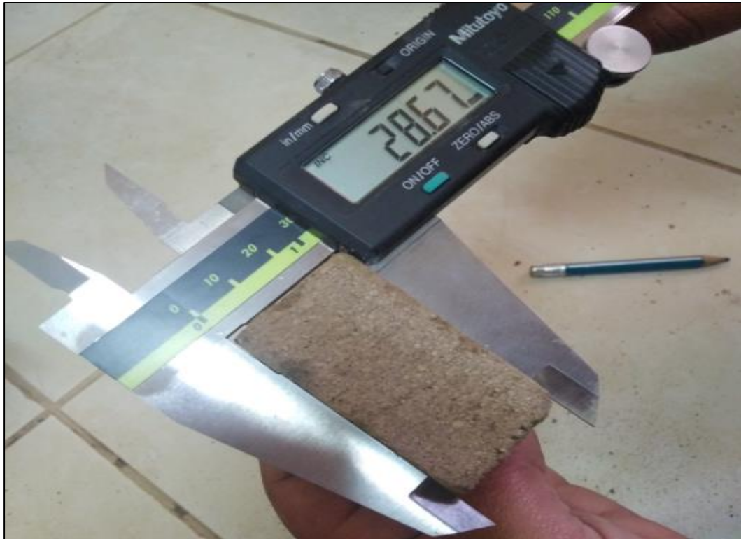
Foto N° 11: Medición del ancho de la unidad de adobe. Fuente: Autoría propia.
