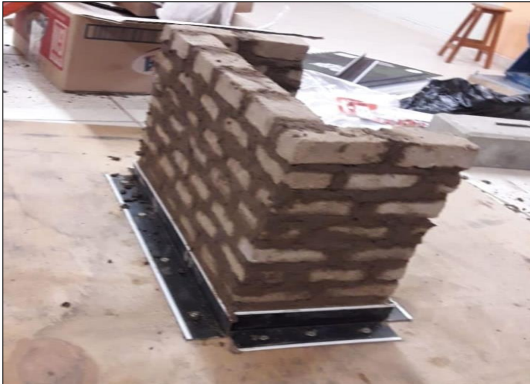
Foto N° 10: Muro a escala de adobe. Fuente: Autoría propia.
