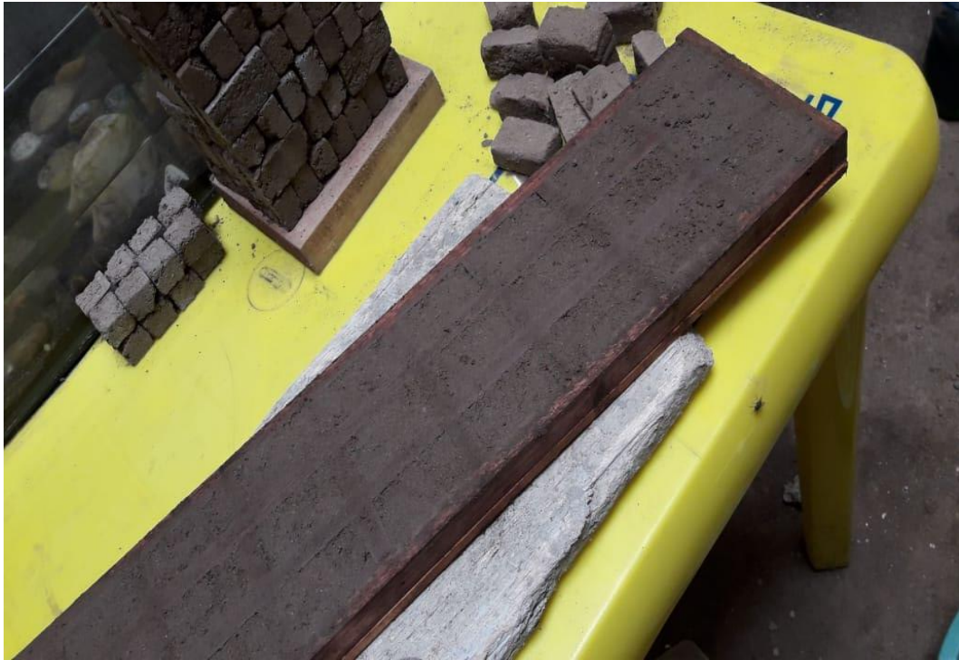
Foto N° 26: Secado a la intemperie, adobes a escala reducida. Fuente: Autoría propia.
