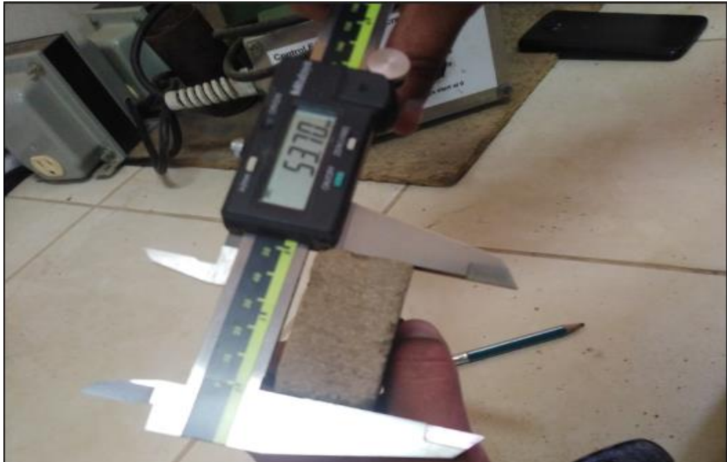
Foto N° 12: Medición del largo de la unidad de adobe. Fuente: Autoría propia.
