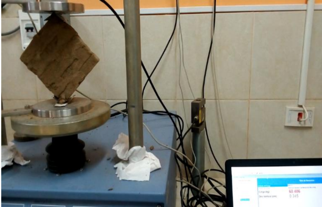
Foto N° 15: Display del software de la prensa hidráulica, aplicado en el Ensayo de Tracción Diagonal. – Tracción diagonal M4. Fuente: Autoría propia.
