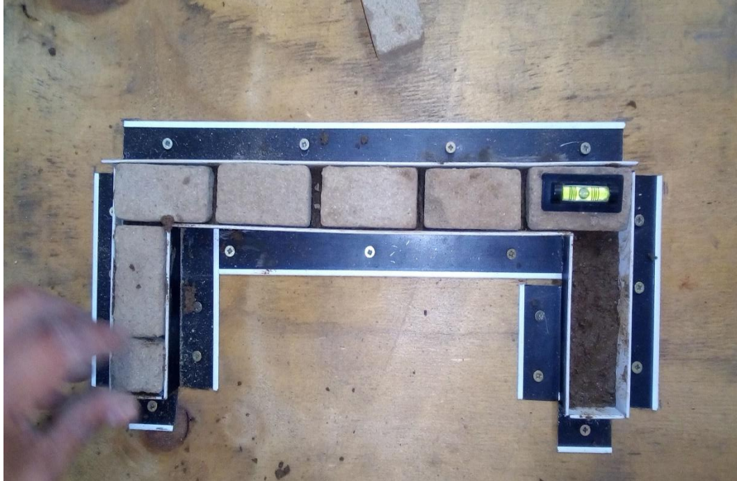
Foto N° 17: Proceso Constructivo de Muros de Adobe a Escala Reducida ¼. Fuente: Autoría propia.
