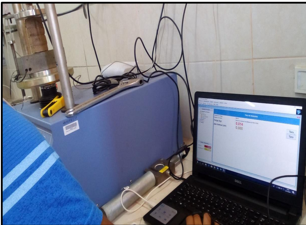
Foto N° 28: Ensayo de laboratorio en prototipo de pila a escala reducida. Fuente: Autoría propia
