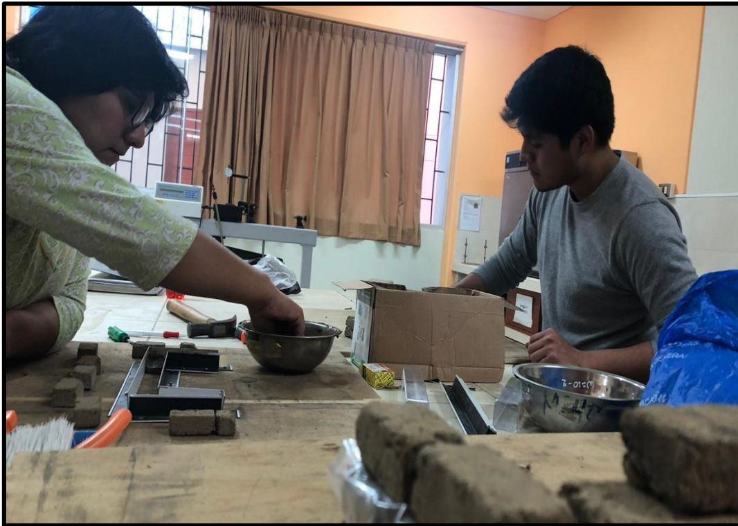
Foto N° 29: Elaborando los prototipos a escala reducida con arriostre de polietileno. Fuente: Autoría propia.
