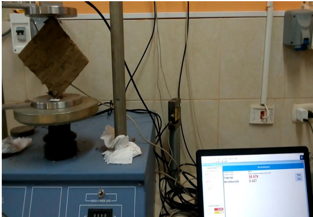
Foto N° 16: Display del software de la prensa hidráulica, aplicado en el Ensayo de Tracción Diagonal. – Tracción Diagonal M3.
