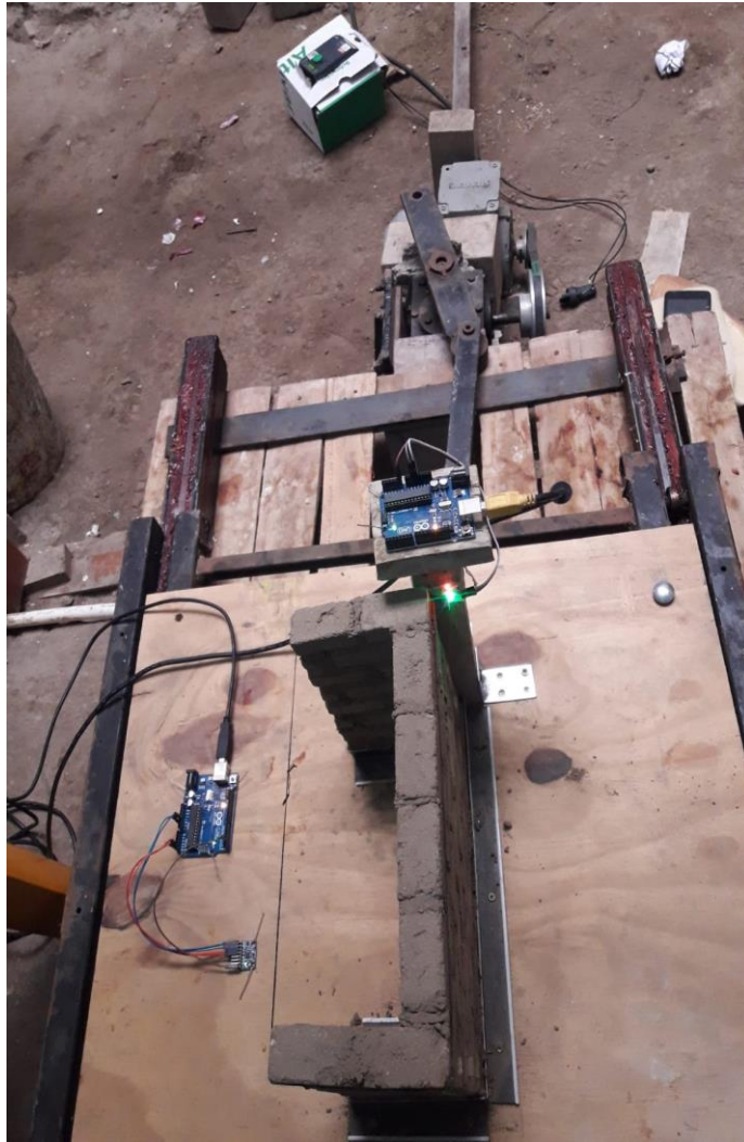
Foto N° 33: Ensayo de muro de tierra a escala reducida en mesa vibratoria. Fuente: Autoría propia.
