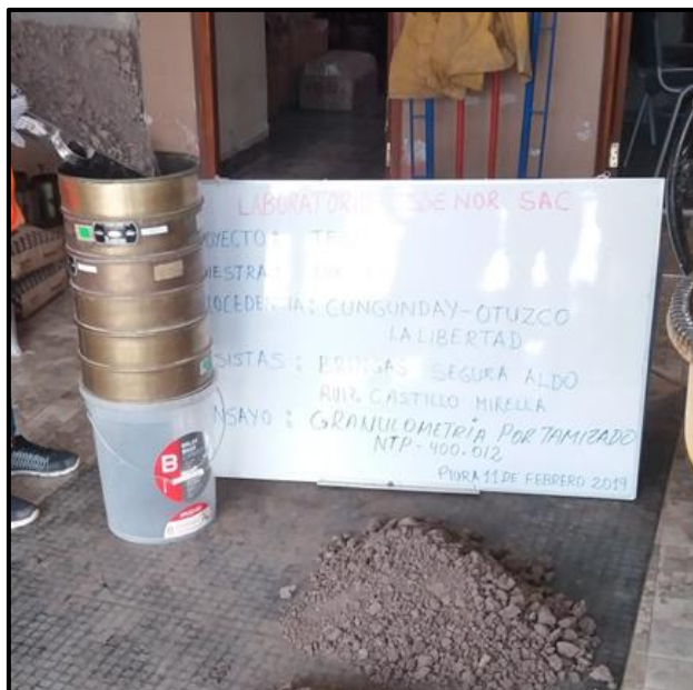
Realización de ensayo Análisis granulométrico por tamizado
