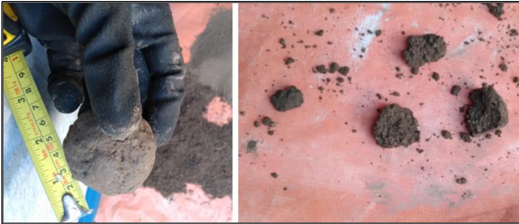
Prueba Empírica para determinar Contenido de humedad según E 0.80
