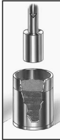
Figura 13.-Compactación de suelos
