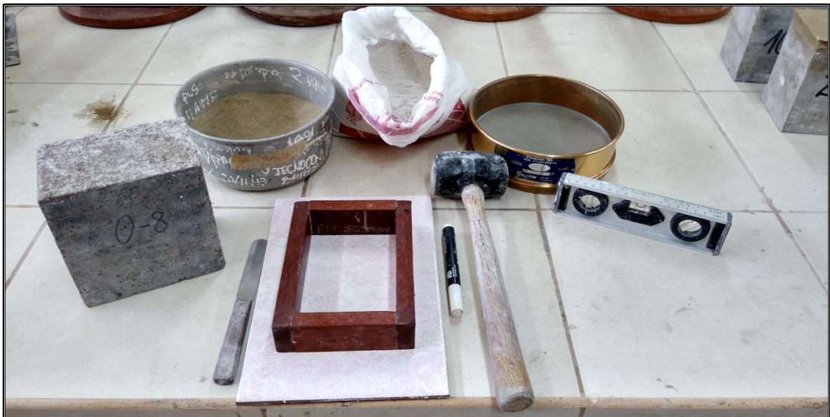
Instrumentos para refrentado de especímenes
