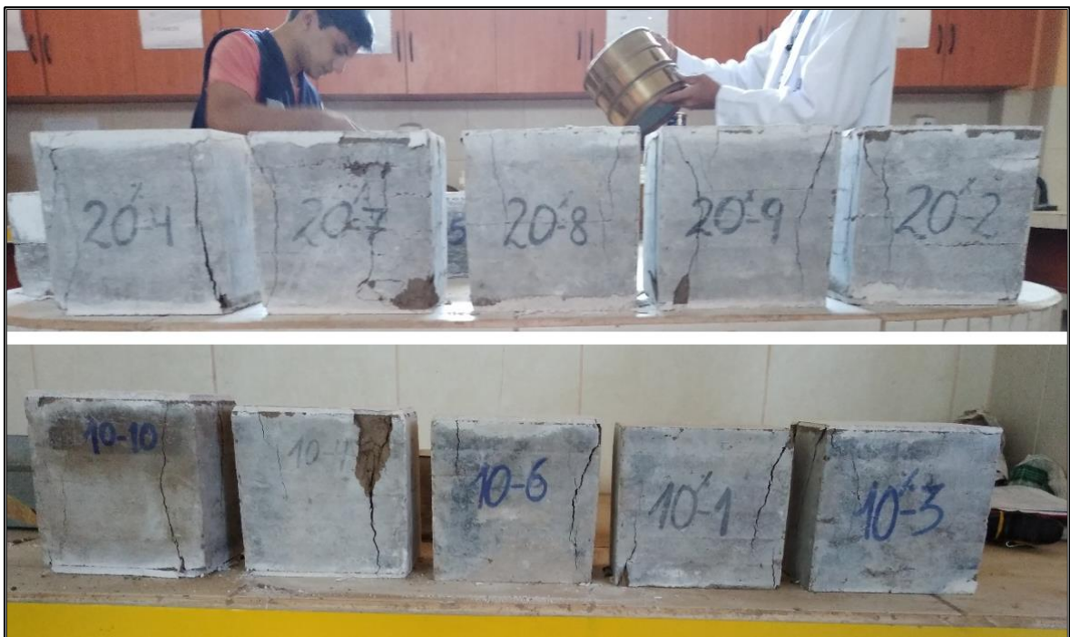
Agrietamiento típico en muestras después de ensayo resistencia a la compresión.
