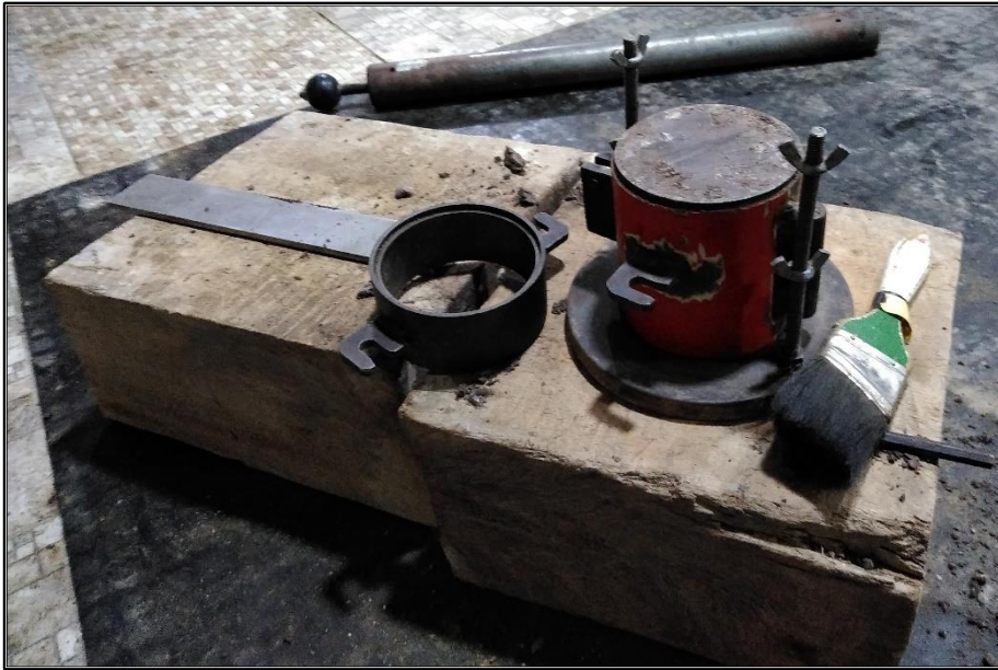
Molde cilíndrico con material compactado
