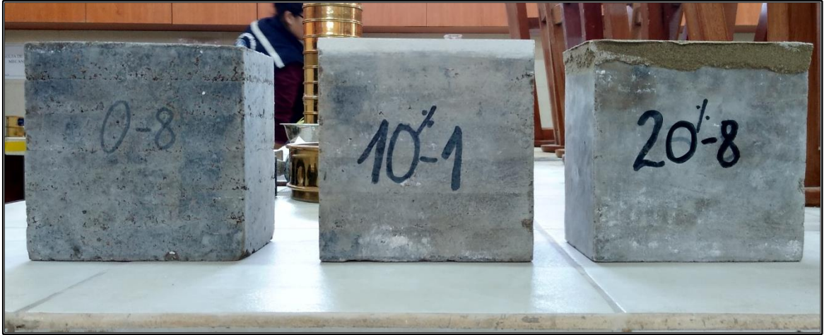
Especímenes del 0%, 10% y 20% con una cara refrentada
