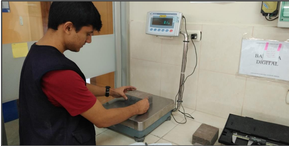
Registro de masa de muestras a los 28 días de secado
