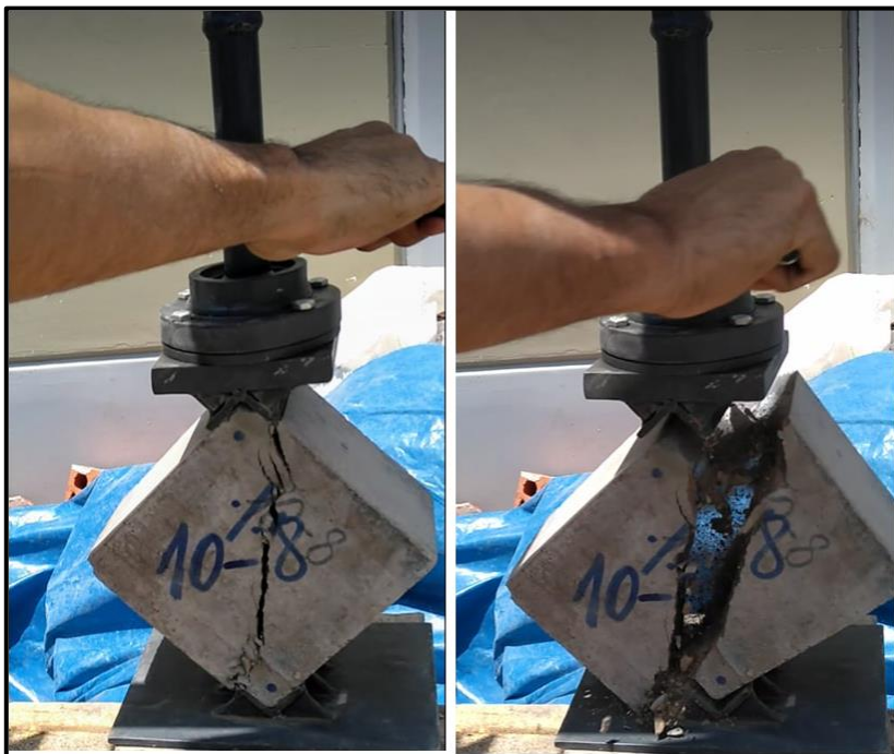
Agrietamiento diagonal de especímenes
