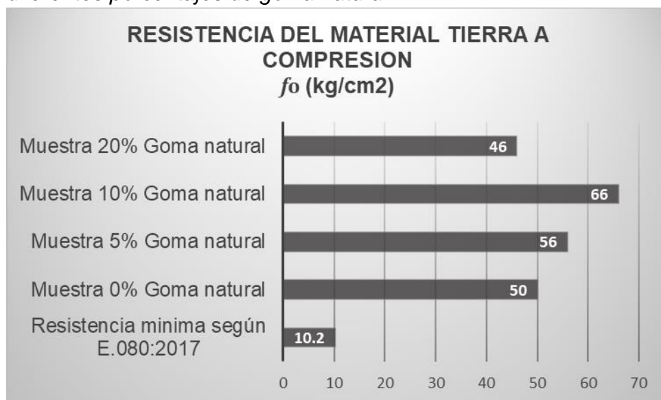
Gráfica 7.-Resistencia del material tierra a compresión, con diferentes porcentajes de goma natural.
