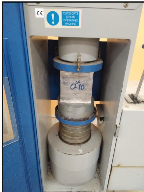
Inicio de ensayo de resistencia a la compresión
