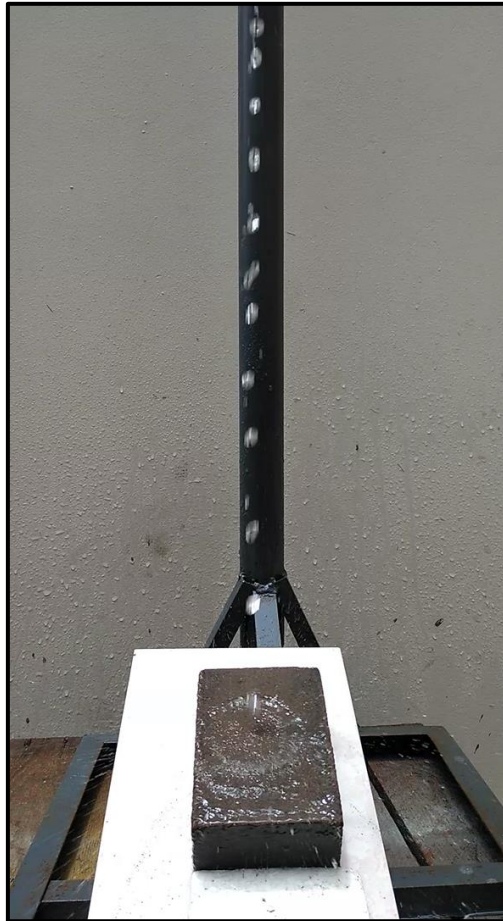
Ensayo Erosión Acelerada Swinburne (SAET)
