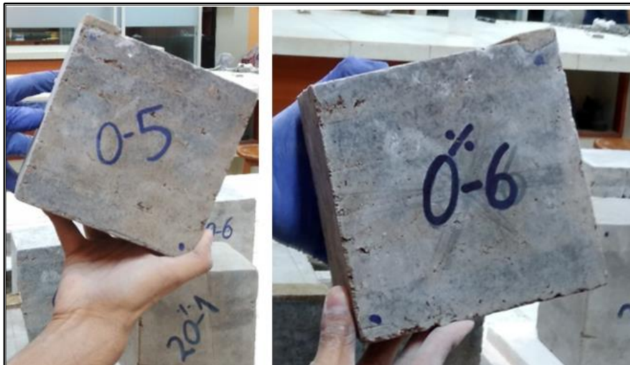
Especímenes para ensayo de resistencia a la compresión diagonal-0% goma natural
