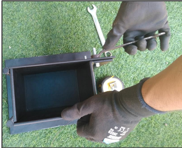
Molde metálico para elaboración de tapial
