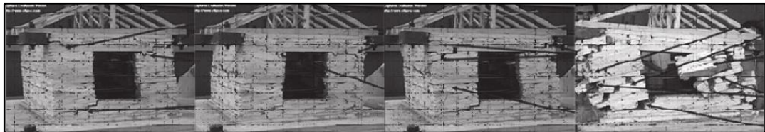
Figura 25.-Prototipo de adobe durante el ensayo en la mesa de simulación de terremotos
