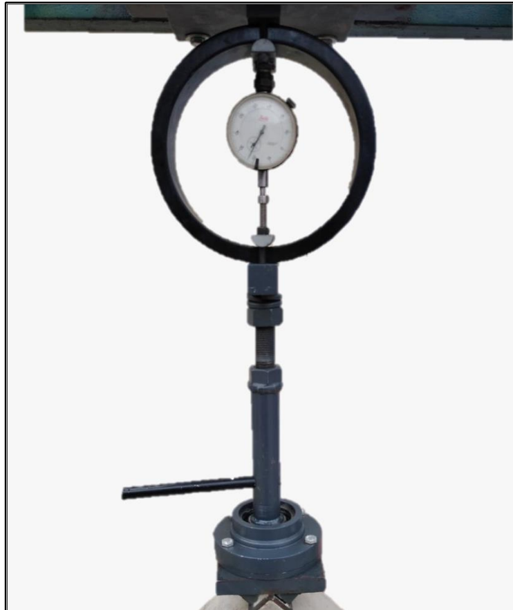
Anillo de carga para ensayo resistencia a la compresión diagonal
