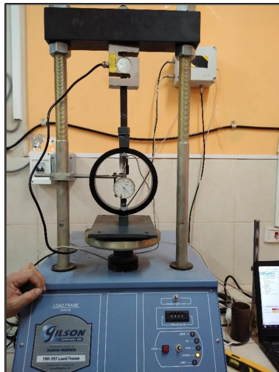
Calibración de Anillo de carga
