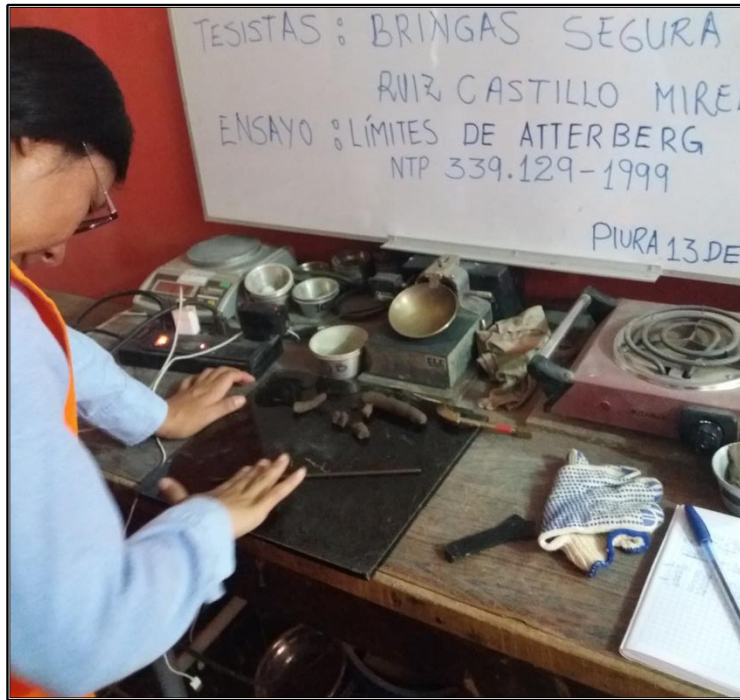
Realización ensayo Límite Plástico
