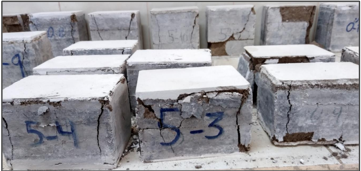
Muestras del 5% ensayadas
