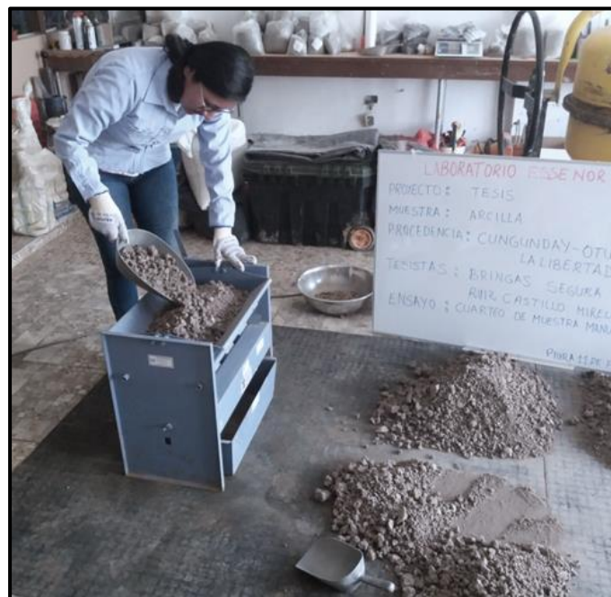
Cuarteo Mecánico del material
