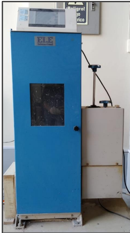
Equipo utilizado para ensayo de resistencia a la compresión.
