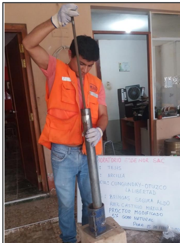
Ejecución de Ensayo de compactación de suelo: Proctor Modificado
