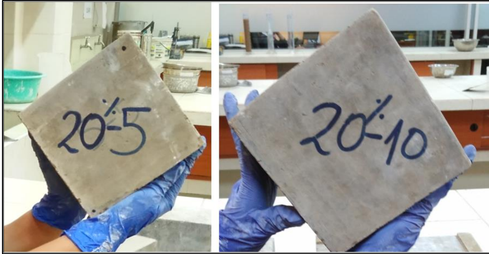
Especímenes para ensayo de resistencia a la compresión diagonal-20% goma natural
