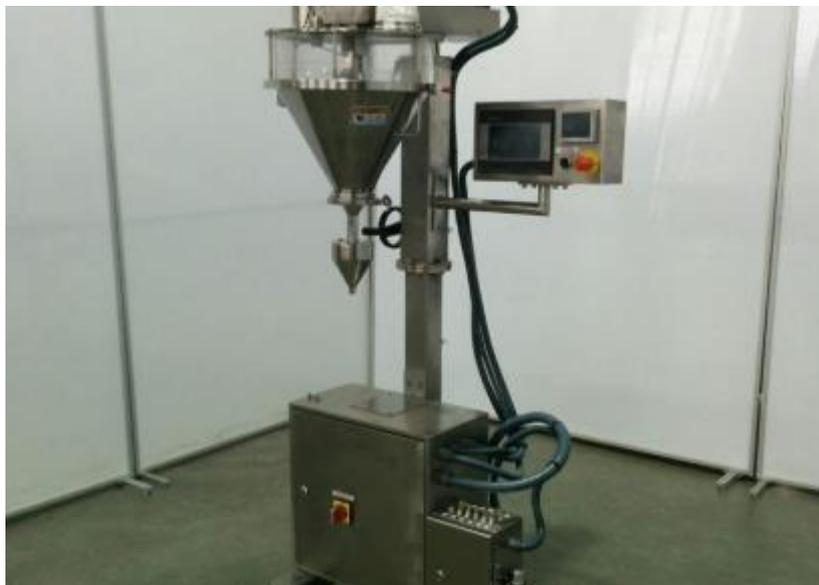
*Figura 6. Dosificador volumétrico.
