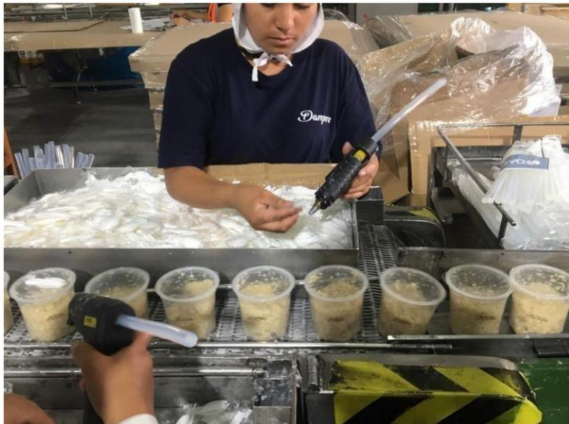
*Figura 1. Proceso de dosificación de silicona.*
