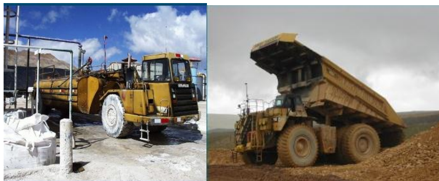
Figura N° 2.3: Adición de cal y descarga de mineral en PAD de Lixiviación
