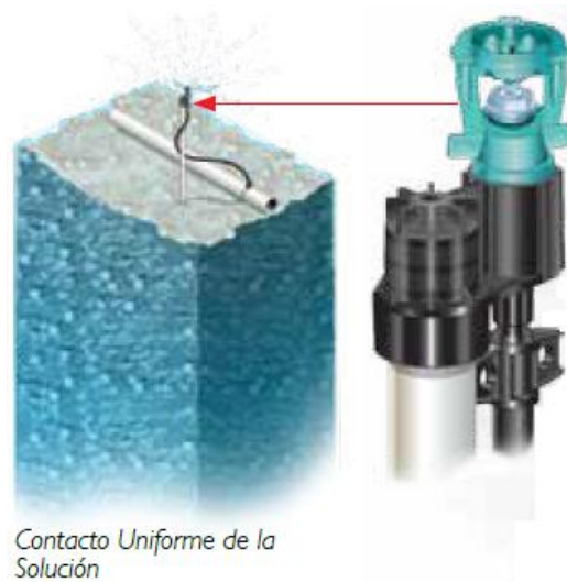
Figura N° 2.8: Técnica de riego por aspersores
