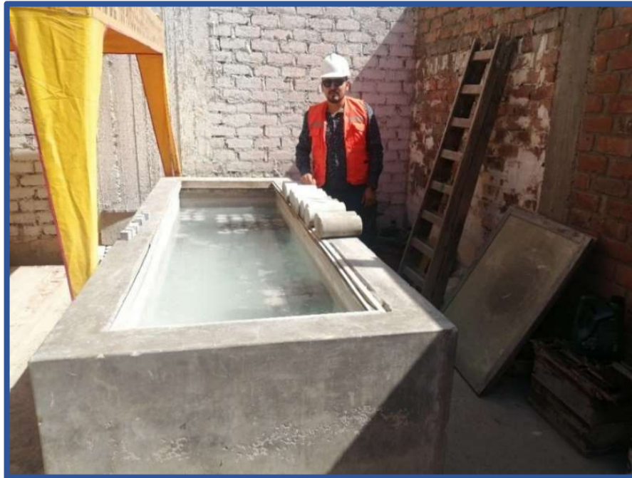
Foto N° 14: Curado de probetas de concreto.
