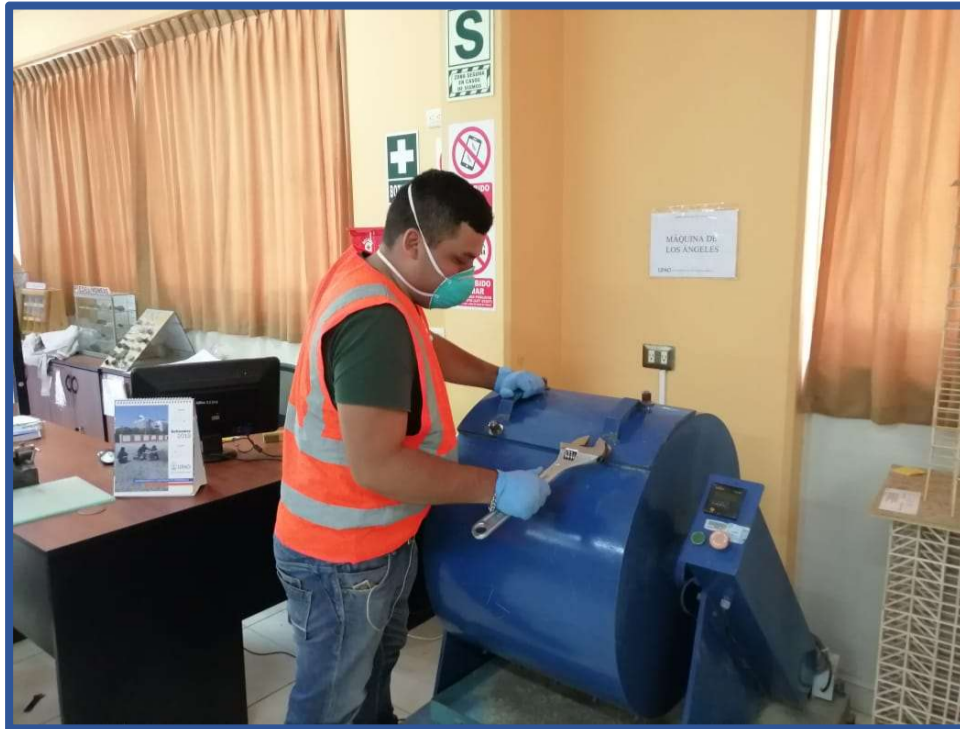
Foto N° 9: Sellado de la Máquina de Los Ángeles
