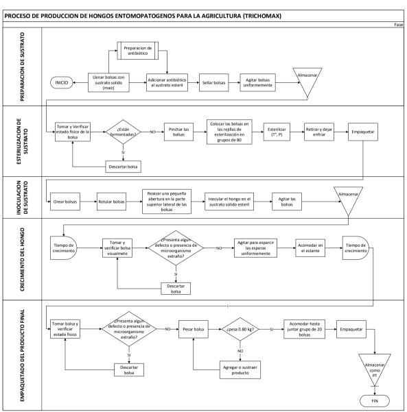
*Nota:* La figura detalla toda la linea de producción de Trichomax y sus procesos, partiendo del primer proceso: preparación de sustrato sólido, hasta el último que es el empaquetado del producto final. Fuente: Elaboración propia
