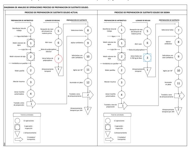
*Nota:* El diagrama muestra un antes y después del proceso de preparación de sustrato en donde se compara nota el cambio. En la izquierda está el proceso actual y en la derecha el proceso propuesto como mejora. Fuente: Elaboración propia
