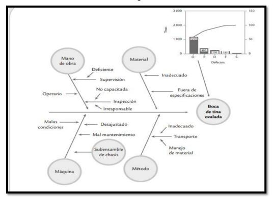
Nota: En la figura se muestra una diagrama causa- efecto para conocer las causas del defecto de las bocas ovaladas de las tinas. Tomado de (Gutierrez Pulido & De la Vara Salazar, 2009)
