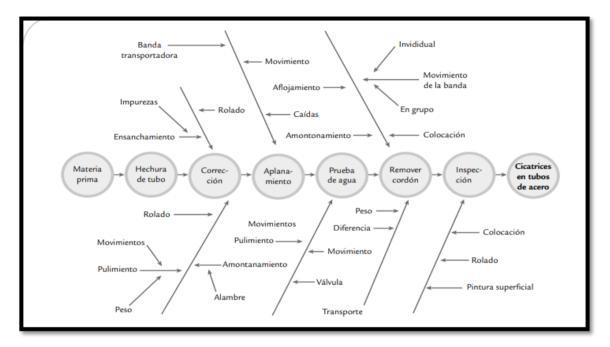
Nota: En la figura se muestra el diagrama de causa- efecto por el método de flujo de procesos para conocer las causas del defecto cicatrices en tubos de acero. Tomado de (Gutierrez Pulido & De la Vara Salazar, 2009)
