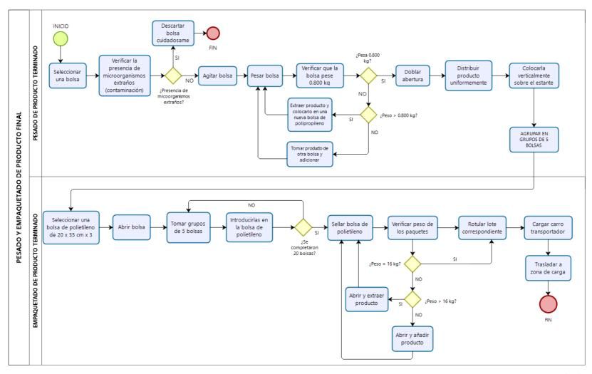
Anexo 39: Diagrama de análisis proceso de pesado y empaquetado de producto final
