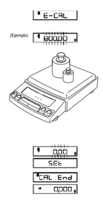
Se ha de realizar la Calibración de la Balanza nuevamente:
