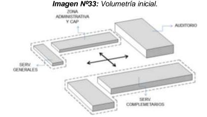
La propuesta es de tendencia horizontal. Presenta una composición semicompacta compuesta por 3 bloques organizados a partir de un espacio central dominante, los elementos de la composición son resultado de paralelepípedos los cuales se fueron modificando en cuanto a rotación y emplazamiento a partir del planteamiento de ejes internos de la composición.
