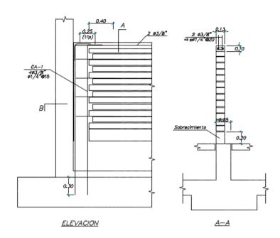
Imagen N°63: Detalle de muro fachada y elevación
