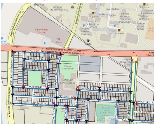
Imagen N°18: Tuberías de Agua Potable
