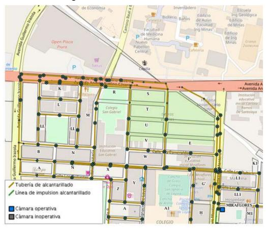
Imagen N°17: Tuberías de Alcantarillado.
