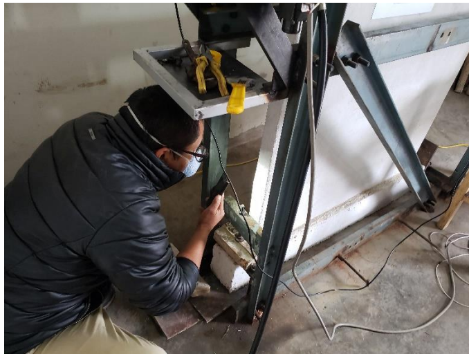
Foto N°51: Revisando el marco rígido y las mangueras hidráulicas
