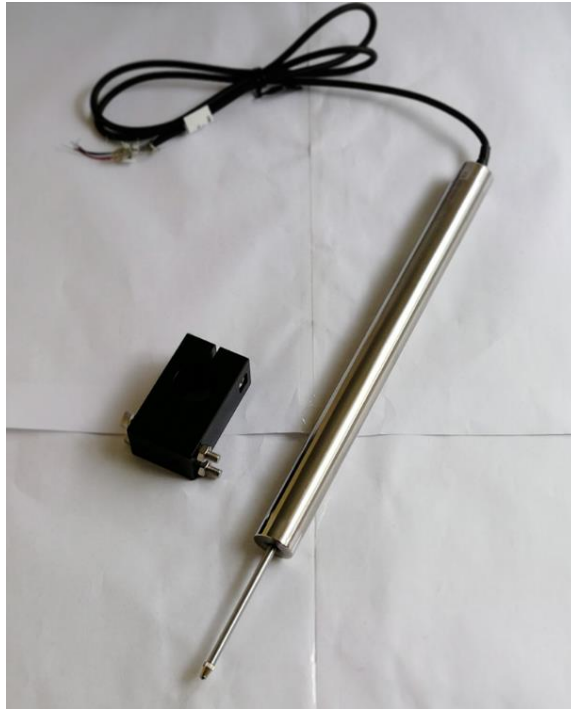
Figura N°13: Transductor de desplazamiento (LVDT)
