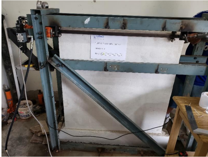
Foto N°48: Muro colocado y listo para el primer ensayo
