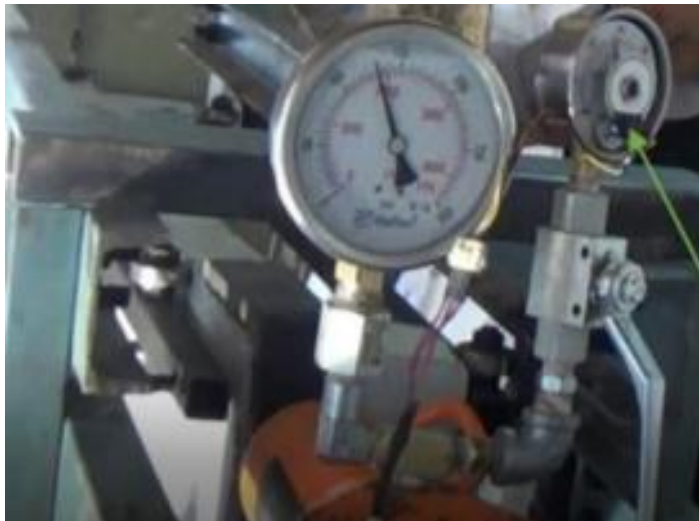
Foto N°06: Gata hidráulica y manómetro que se usaron en los ensayos originales
