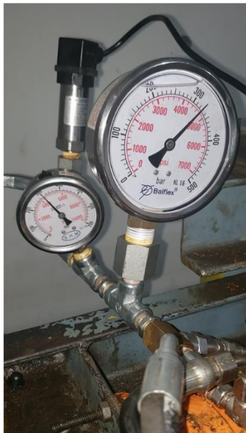
Foto N°81 N°82: Válvula que cerro el pase de aceite hidráulico y soporte que no aguanto la carga lateral
