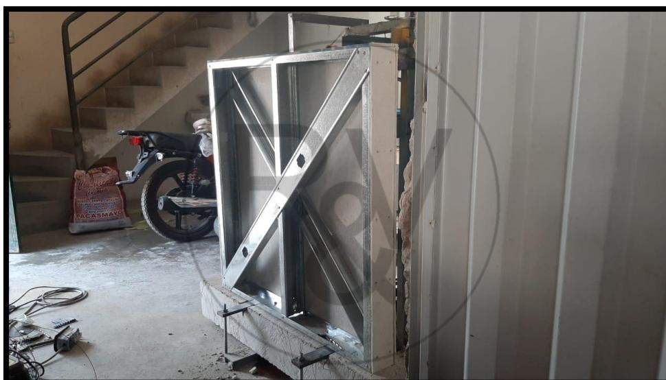
**Figura N°61: Prototipo N°3 – Placa 8mm.**
