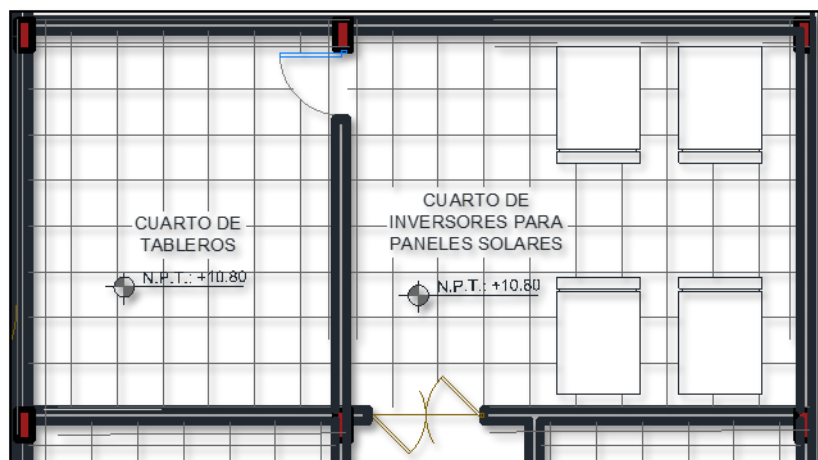
FIGURA N° 100: Cuarto de inversores para Paneles solares
