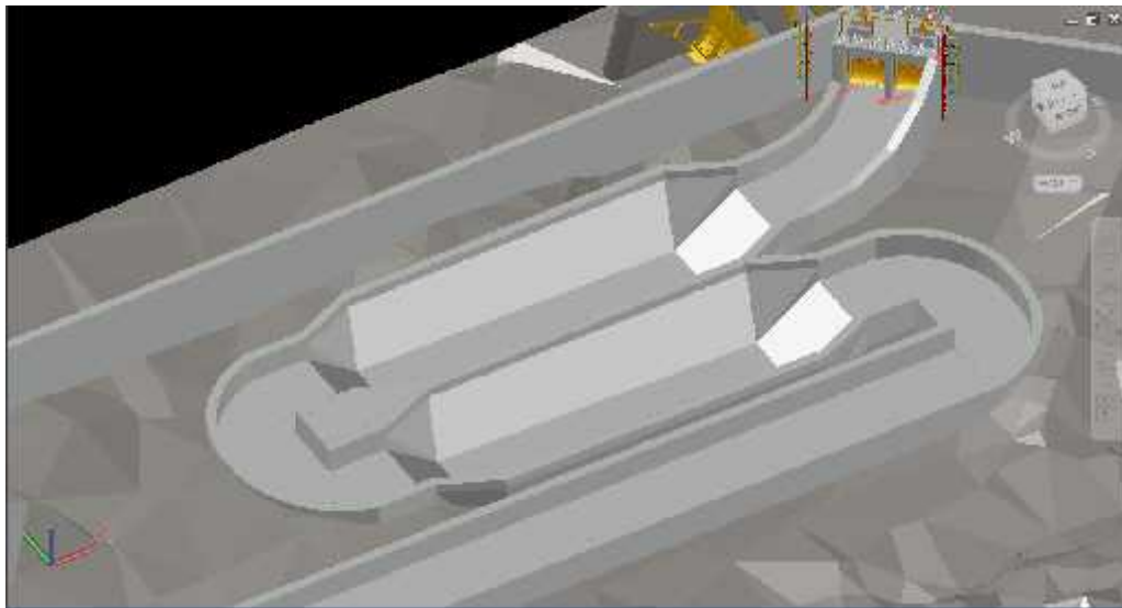
Imagen 34 -ACOPLAMIENTO DE LOS DESARENADORES EN EL SISTEMA DE CAPTACIÓN Fuente: Autoría propia
