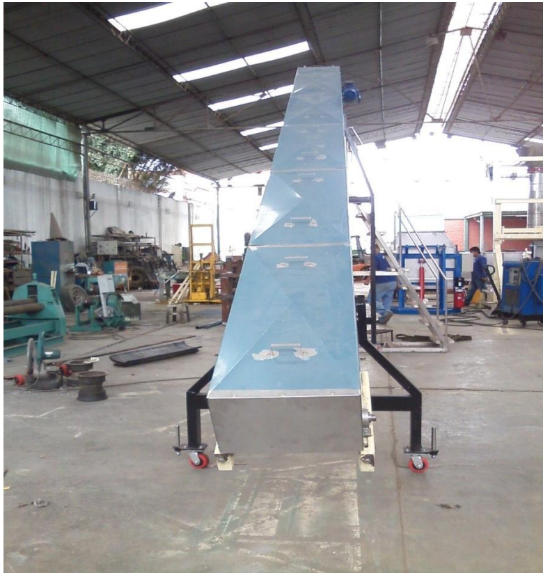
Estructura de elevador
