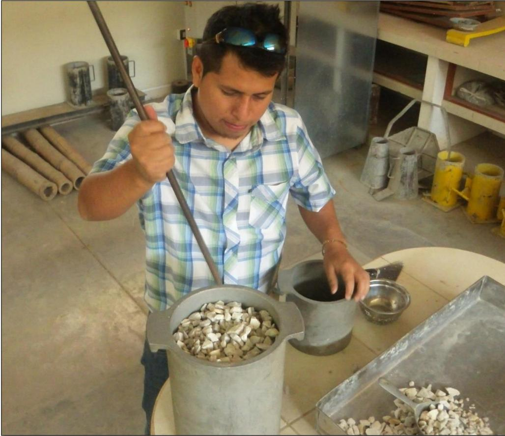
**IMAGEN N° 13** Ensayo del peso unitario realizado en el laboratorio de materiales Upao.
