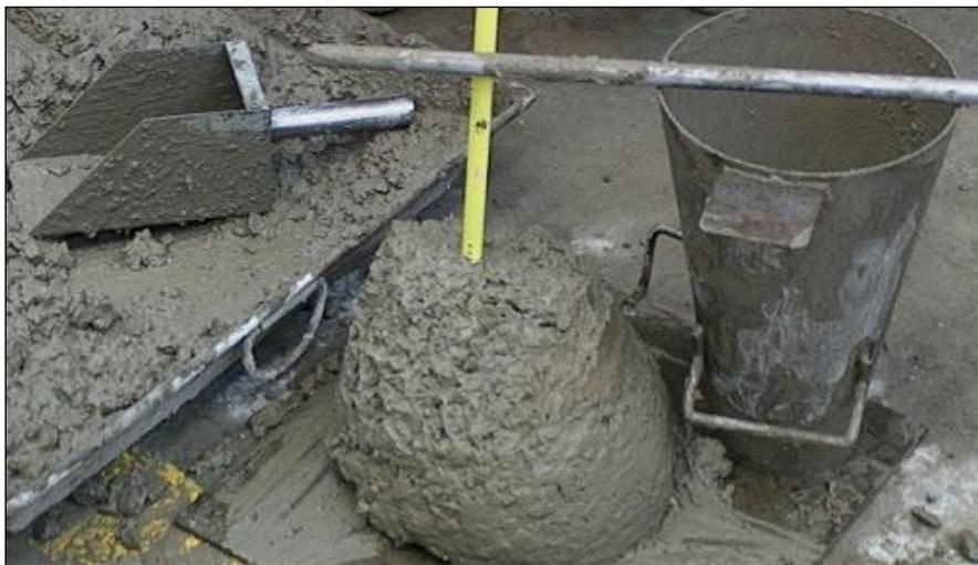
**IMAGEN N° 07** - Ensayo de Consistencia del concreto
