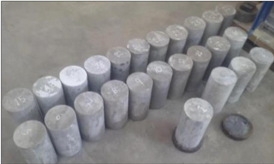
**IMAGEN N° 16** prueba de testigos listas para ser usadas en el ensayo de compresión.
