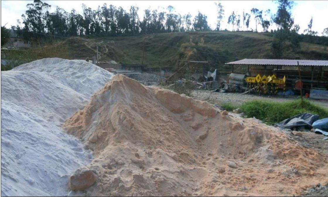
IMAGEN N° 09 - agregado fino de dos tonalidades puesto en obra para ser utilizado
