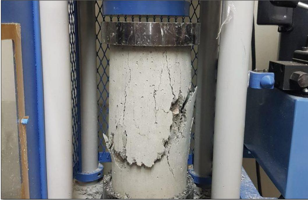
**IMAGEN N° 17** Rotura a la compresión de prueba de testigos – falla por corte.
