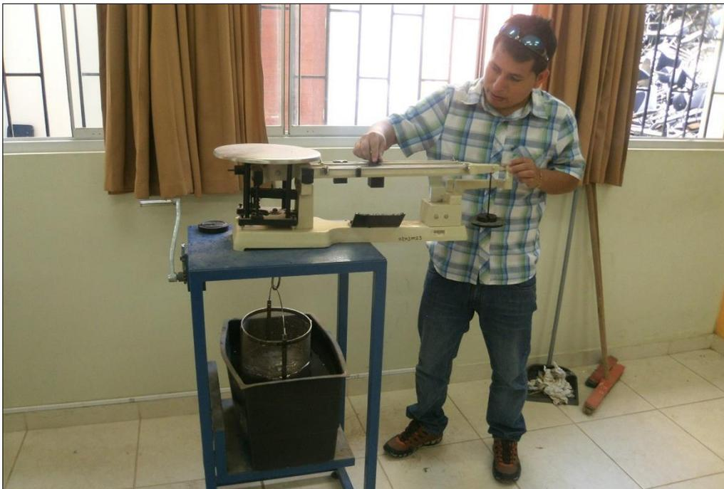
**IMAGEN N° 14** Ensayo de Peso específico realizado en el laboratorio de materiales Upao.
