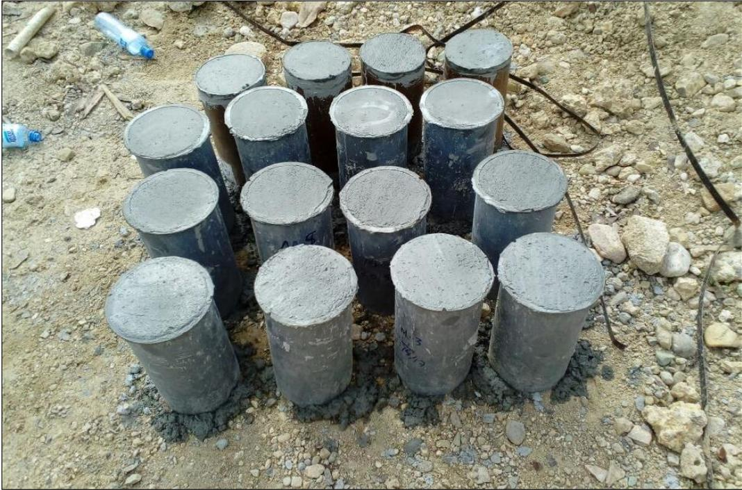
**IMAGEN N° 15** Elaboración de la prueba de testigos en moldes de 30cm de alto x 15cm de diámetro.
