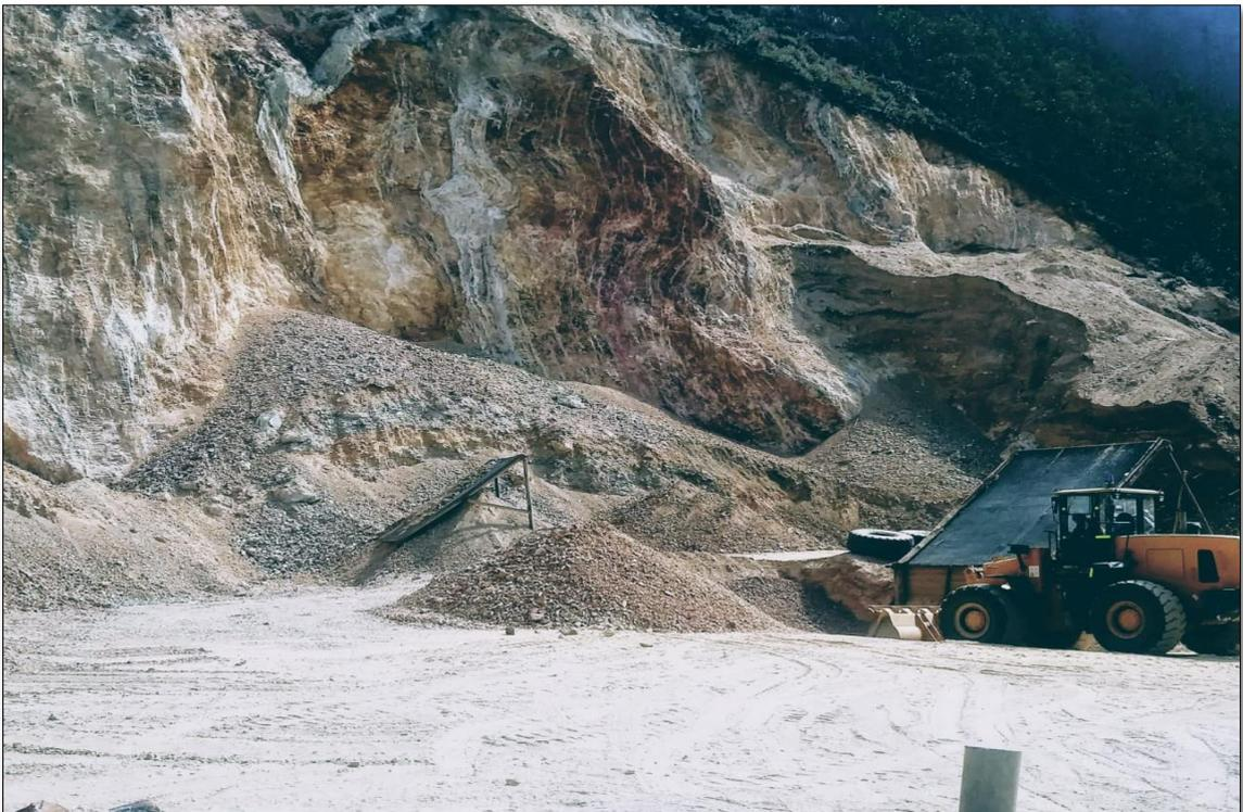
**GRAFICA N° 05** - Extracción y proceso de zarandeo del agregado cuarcita
