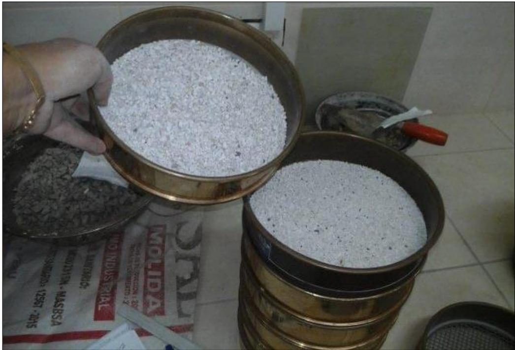
IMAGEN N° 12 Pesado del agregado grueso retenido en los tamices, realizando el ensayo de granulometría.
