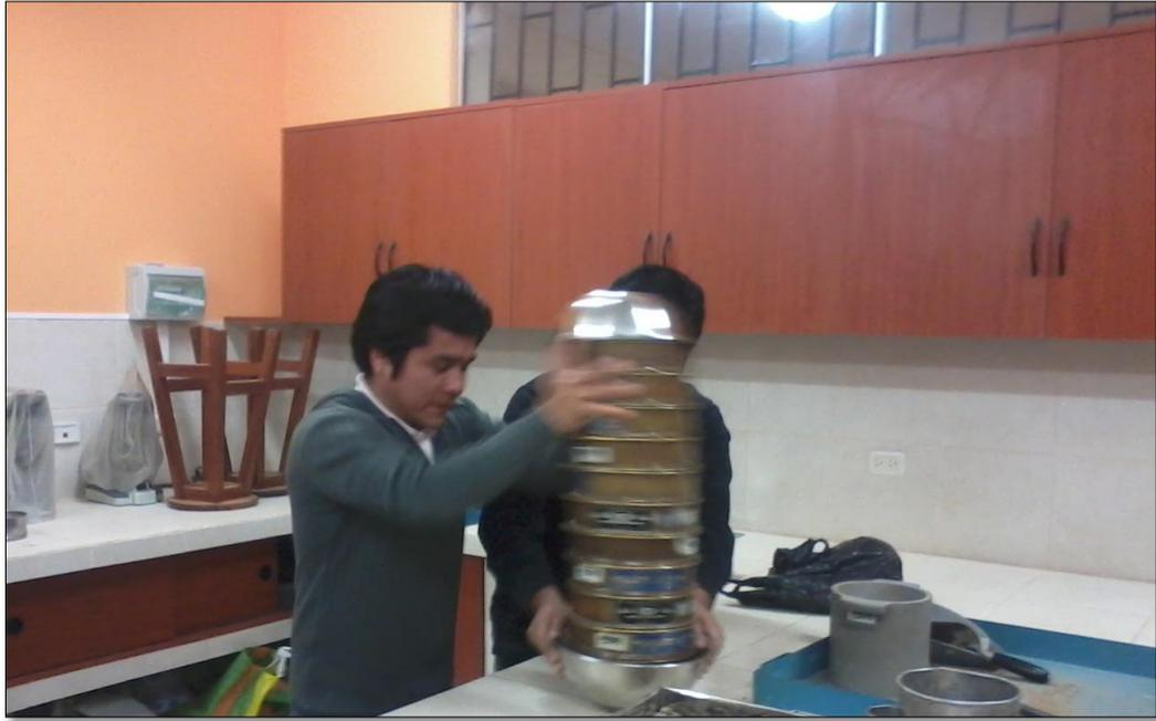
IMAGEN N° 11 - Ensayo de granulometría realizado en el laboratorio de materiales Upao.
