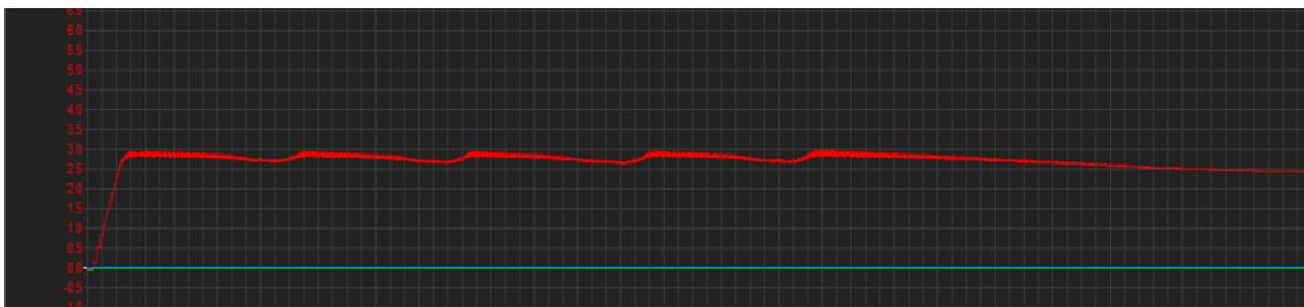
Figura 39: Señal de voltaje en el capacitor de 100uF del circuito inicial, aplicando 5 pulsaciones en el generador
