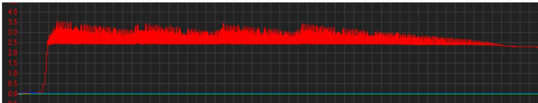
Figura 49: Señal de voltaje en el capacitor de 1uF del circuito inicial, aplicando 4 pulsaciones en el generador
