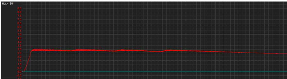
Figura 38: Señal de voltaje en el capacitor de 100uF del circuito inicial, aplicando 4 pulsaciones en el generador
