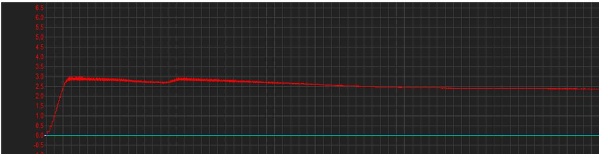
Figura 36: Señal de voltaje en el capacitor de 100uF del circuito inicial, aplicando 2 pulsaciones en el generador
