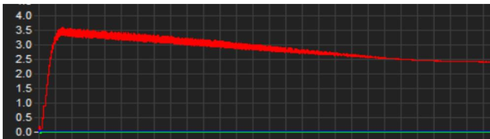
Figura 66: Señal de voltaje en el capacitor de 100uF del circuito final, aplicando 1 pulsación en el generador
