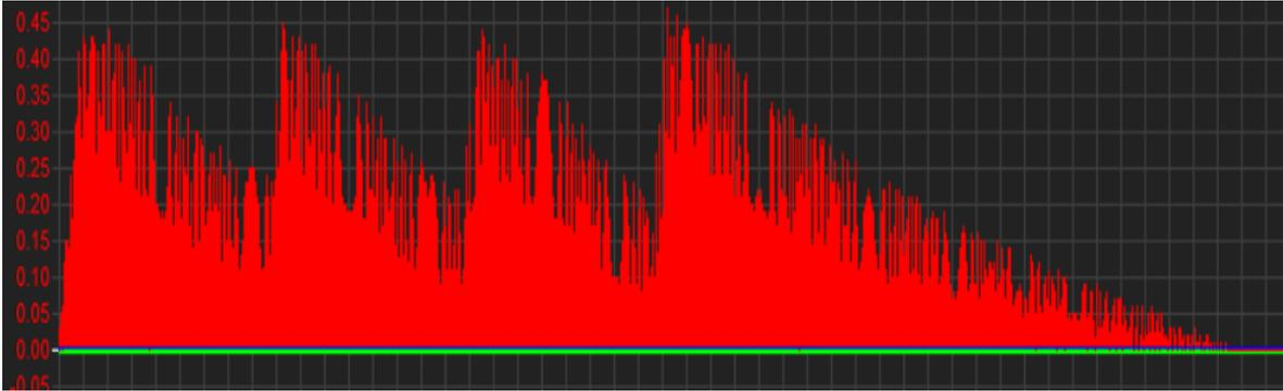
Figura 44: Señal de voltaje en la resistencia aplicando 4 pulsaciones en el generador, utilizando el capacitor de 1uF en circuito final
