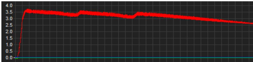
Figura 68: Señal de voltaje en el capacitor de 100uF del circuito final, aplicando 3 pulsaciones en el generador
