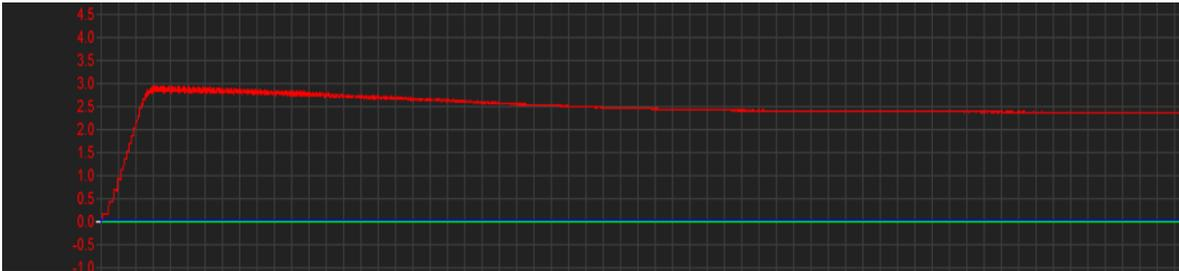
Figura 35: Señal de voltaje en el capacitor de 100uF del circuito inicial, aplicando 1 pulsación en el generador
