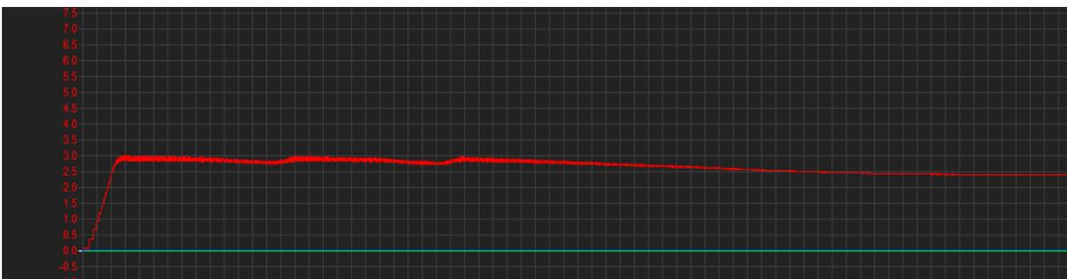
Figura 37: Señal de voltaje en el capacitor de 100uF del circuito inicial, aplicando 3 pulsaciones en el generador
