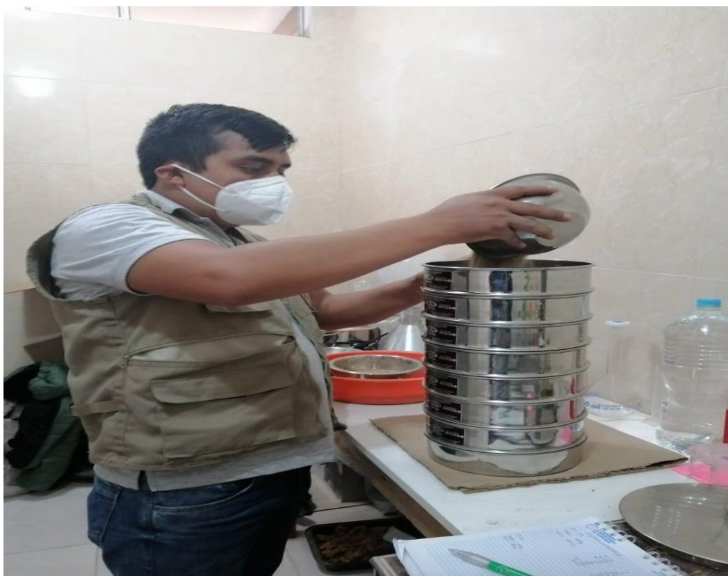
Foto N° 17: tamizado manual calicata 3.
