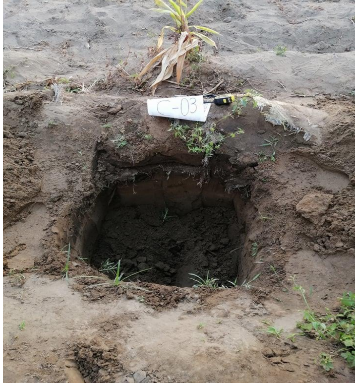
Foto N°7: excavación de la calicata 3, profundidad 1.50m.
