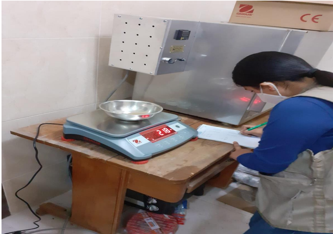
Foto N° 21: anotando pesos retenidos en cada malla calicata 4.
