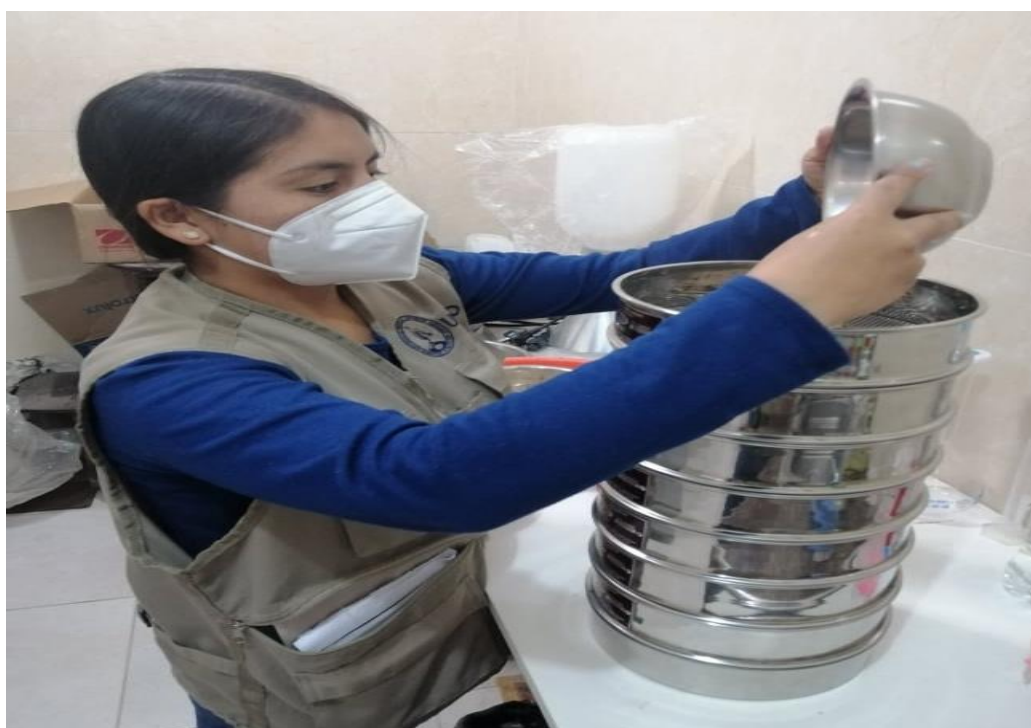
Foto N° 18: tamizado manual calicata 4
