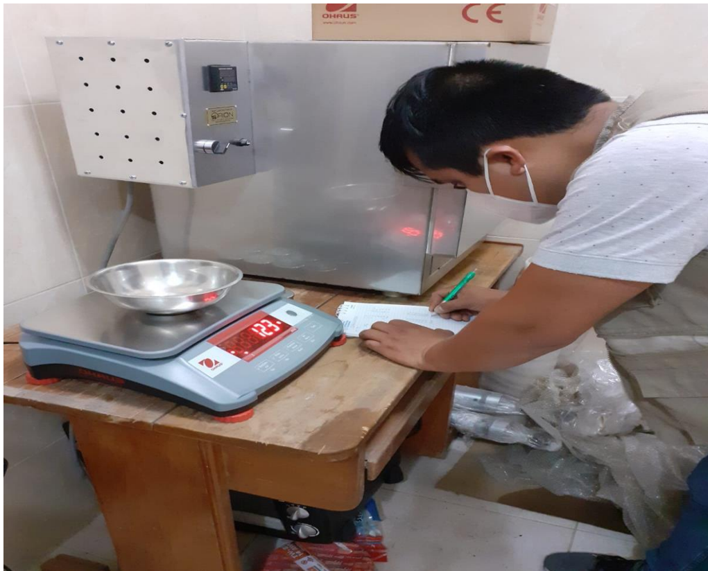
Foto N° 20: anotando pesos retenidos en cada malla calicata 3.
