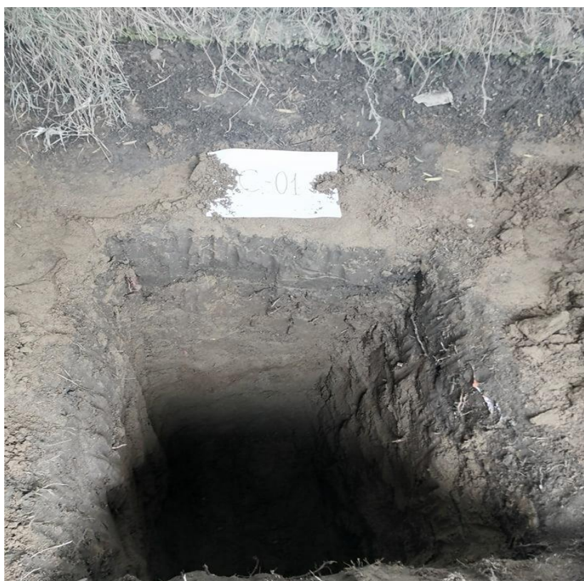
Foto N° 5: Excavación de la calicata 1, profundidad 1.50m.
