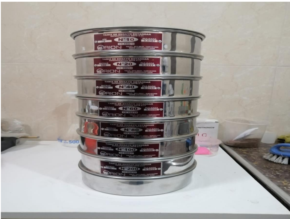
Foto N° 16: tamices utilizados para ensayo. Análisis Granulométrico por tamizado.
