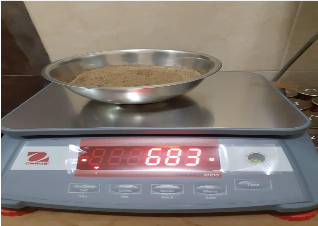
Foto N° 15: peso de muestra para tamizado.
