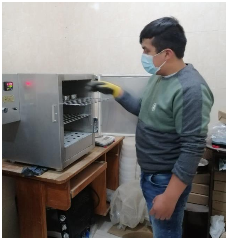
Foto N° 14: sacando las muestras después de 24 hrs, para calcular el contenido de humedad.
